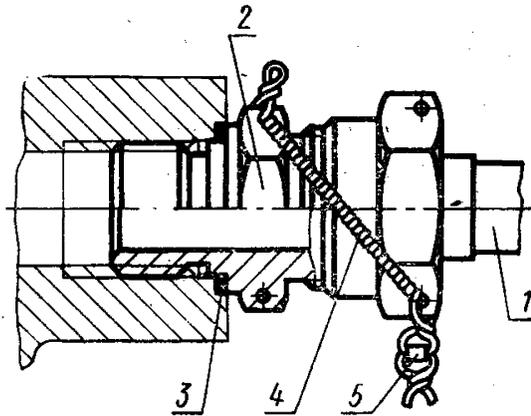
1—труба в сборе по ГОСТ 13954—74; 2—проходник ввертной под металлическое уплотнение по ГОСТ 20194—74; 3—кольцо уплотнительное; 4—проволока; 5—пломба
