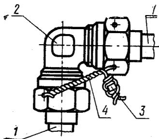
1—труба в сборе по ГОСТ 13954—74; 2—угольник проходной по ГОСТ 13962—74; 3—пломба; 4—проволока.
