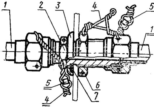
1—труба в сборе по ГОСТ 13954—74; 2—проходник прямой герметизируемый по ГОСТ 20188—74; 3—шайба по ГОСТ 20193—74; 4—проволока; 5—пломба; 6—гайка по ГОСТ 13958—74; 7—прокладка уплотнительная
