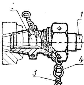
1—труба в сборе по ГОСТ 13954—74; 2—угольник ввертной по ГОСТ 13969—74; 3—проволока; 4—пломба.
