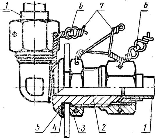
1—труба в сборе по ГОСТ 13954—54; 2—угольник фланцевый проходной герметизируемый по ГОСТ 20189—74; 3—гайка по ГОСТ 13958—74; 4—прокладка уплотнительная; 5—шайба по ГОСТ 20193—74; 6—пломба; 7—проволока.
