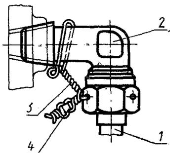
1—труба в сборе по ГОСТ 13954—74; 2—угольник ввертной по ГОСТ 13970—74; 3—проволока; 4—пломба.
