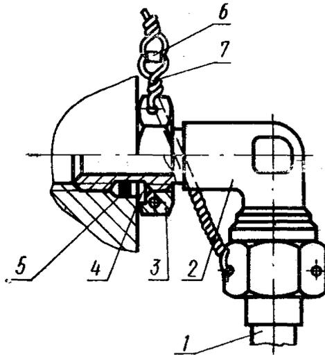
1—труба в сборе по ГОСТ 13954—74; 2—угольник ввертной под резиновое уплотнение по ГОСТ 20198—74; 3—гайка по ГОСТ 19532—74; 4—шайба по ГОСТ 19531—74; 5—кольцо уплотнительное по ГОСТ 9833—73; 6—пломба; 7—проволока.
