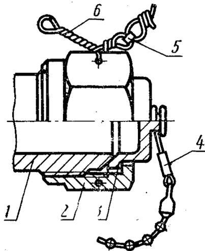
1—резьбовая часть арматуры по ГОСТ 13955—74; 2—гайка накидная по ГОСТ 13957—74; 3—крышка по ГОСТ 13976—74; 4—подвеска; 5—пломба; 6—проволока.
