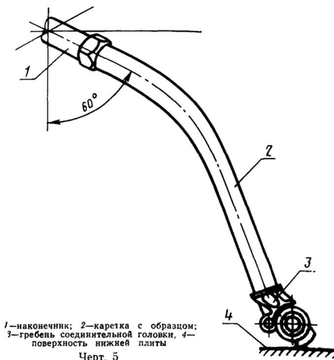
Перед испытанием производят сборку образца рукава с металлической арматурой в соответствии с требованиями ГОСТ 2593—82.
