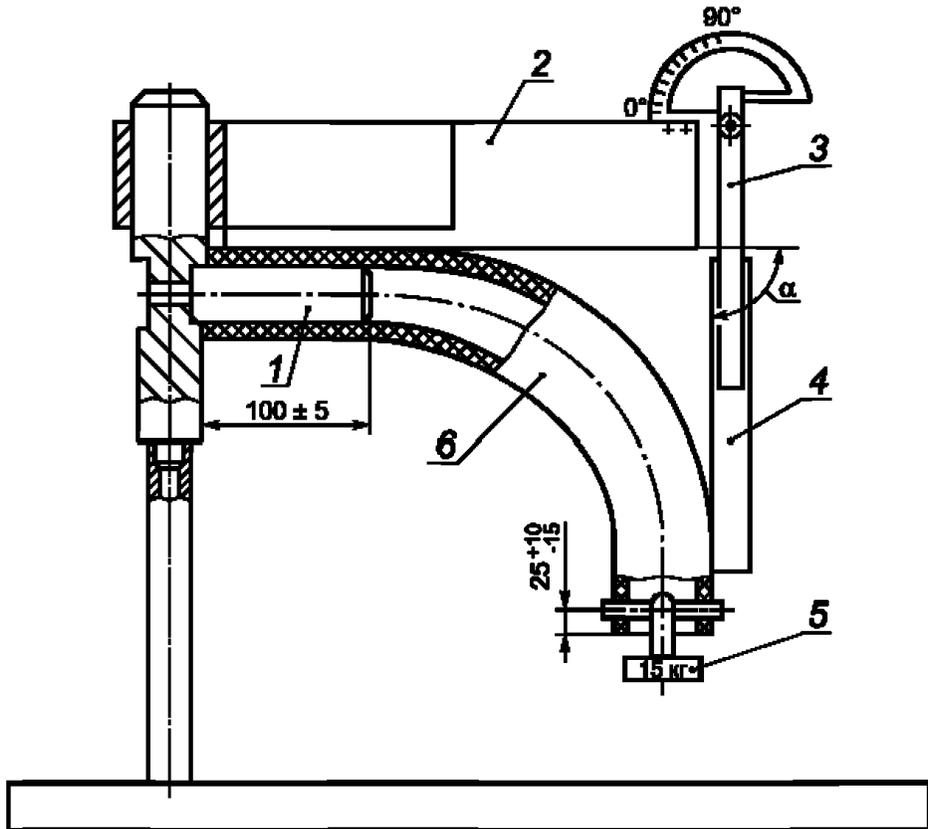
1 — съемный стержень; 2 — приспособление для фиксирования и измерения угла; 3 — угломер типа 4 по ГОСТ 5378—88; 4 — планка для удлинения измерительной поверхности угломера; 5 — груз; 6 — рукав;  $\alpha$  — измеряемый угол  $90^\circ_{-5^\circ}$ .
