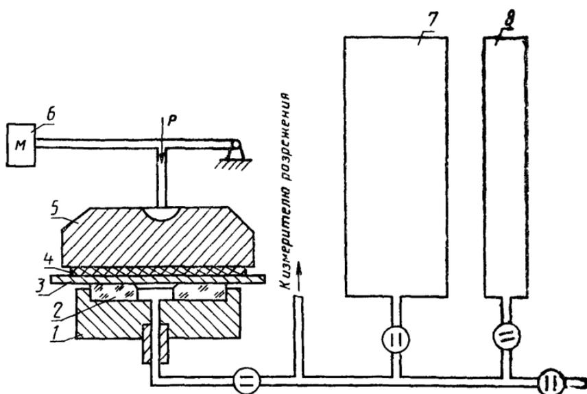
1 — опорный столик; 2 — стеклянная пластина; 3 — испытуемый образец; 4 — резиновая прокладка; 5 — прижимной диск; 6 — рычаг с грузом; 7 — вакуумная камера вместимостью 380 см<sup>3</sup>; 8 — вакуумная камера вместимостью 38 см<sup>3</sup>
