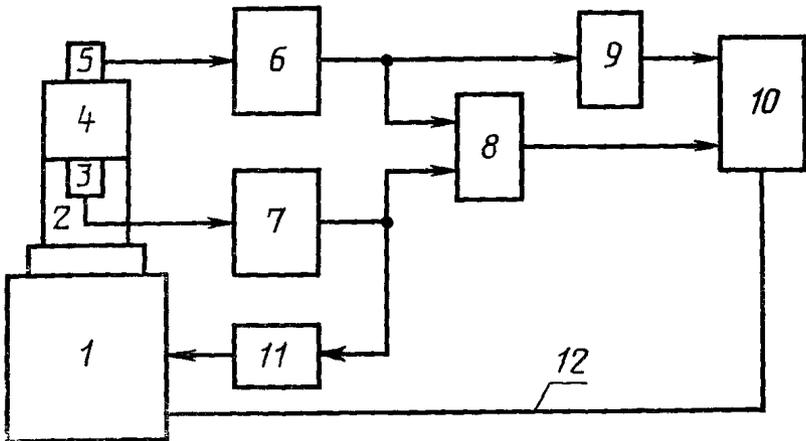
1—вибростенд; 2—переходной элемент; 3, 5—вибропреобразователи ускорения; 4—объект испытания; 6, 7—усилители; 8—фазометр; 9—усилитель с детектированием выходного сигнала; 10—регистрирующее устройство; 11—блок экстренного выключения вибростенда; 12—синхронизация регистратора от генератора вибростенда
