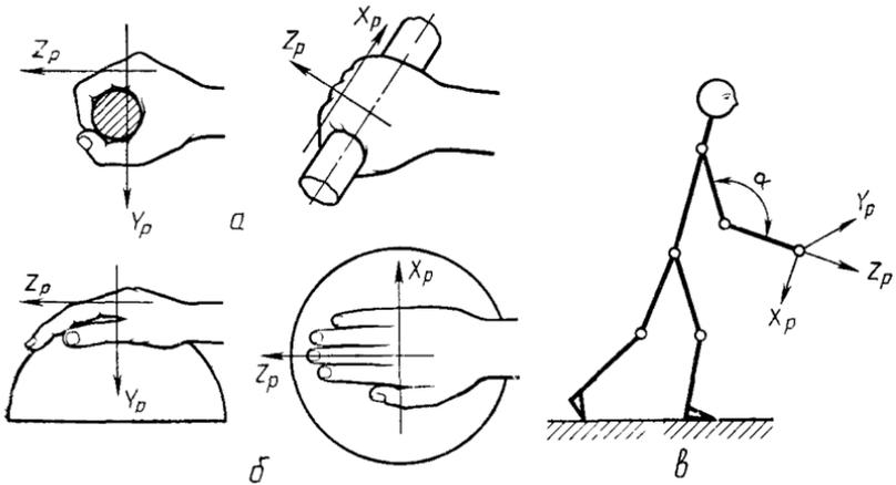
*a*—при обхвате цилиндрических и торовых поверхностей; *б*—при обхвате сферических поверхностей; *в*—направление осей относительно тела человека
