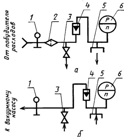
а — режим «выдоха», б — режим «вдоха»; 1 — зажим; 2 — фильтр; 3 — регулировочный вентиль; 4 — ротаметр; 5 — насадка для подключения устройства, герметизирующего лицевую часть; 6 — тягонапормер
