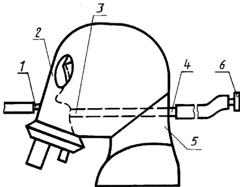
1 — штуцер; 2 — лицевая часть СИЗОД; 3 — лицевой конец муляжной трубки; 4 — затылочный конец муляжной трубки; 5 — муляж головы; 6 — разъем для подключения к насадке установки (черт. 2 настоящего стандарта)
