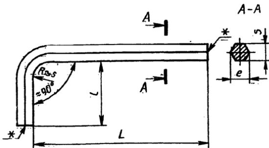
\* Кромки могут быть острыми, закругленными или с фасками. Радиус закругления или фаска должны быть не более половины разницы между размерами  $e$  и  $s$ .
