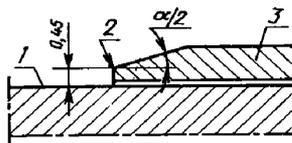
1 — поверхность стебля; 2 — измерительная кромка; 3 — барабан
