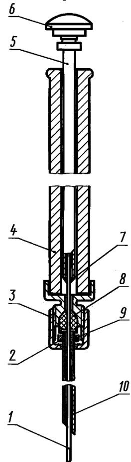
1 — поршень; 2 — прокладка; 3 — гайка накидная; 4 — корпус МШ-1; 5 — шток МШ-1; 6 — головка МШ-1; 7 — пайка; 8 — сальник; 9 — фланец иллы; 10 — игла
