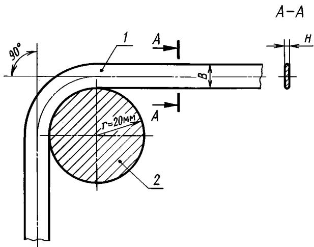
1.3. Образцы плющеной ленты должны выдерживать испытание на ребровый изгиб в положении, показанном на черт. 1. Угол изгиба принимается равным  $90^\circ$ .
