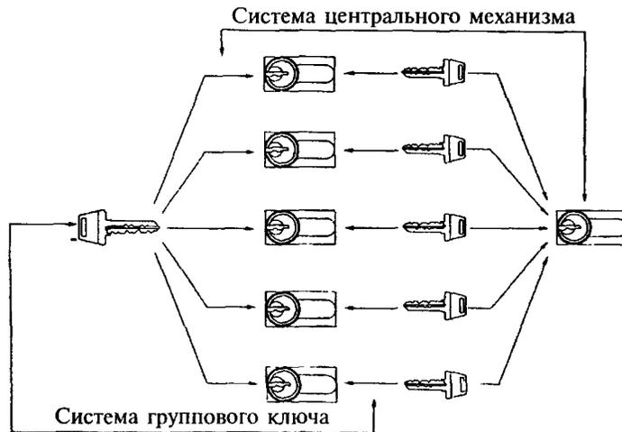
**Рисунок Б.6** — Смешанная система цилиндрических механизмов — система, представляющая собой соединение систем цилиндрических механизмов с групповым ключом и центральным механизмом, каждый механизм которой можно открывать и закрывать центральным ключом
