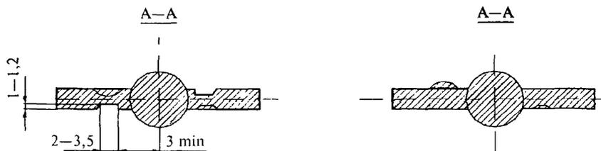
Рисунок В.46 — Пример ключа для врезного сувальдного замка, тип ЗС1
