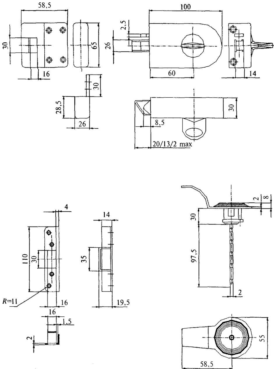
**Рисунок В.17** — Пример замка накладного цилиндрического типа ЗН2 с автоматическим выводом засова-заселки
