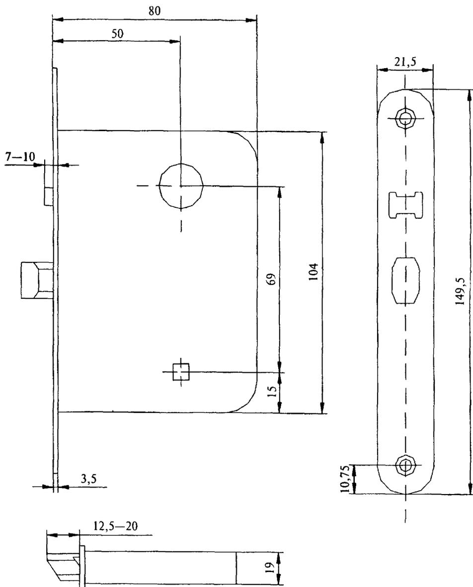
**Рисунок В.9** — Пример замка врезного цилиндрического типа 3В7 с автоматическим выводом засова-заселки
