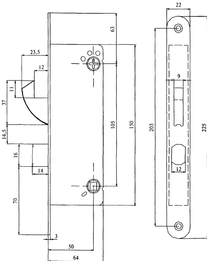
**Рисунок В.12** — Пример замка врезного цилиндрического типа ЗВ7 с защелкой и крюкообразным засовом для дверных блоков из поливинилхлоридных или алюминиевых деталей
