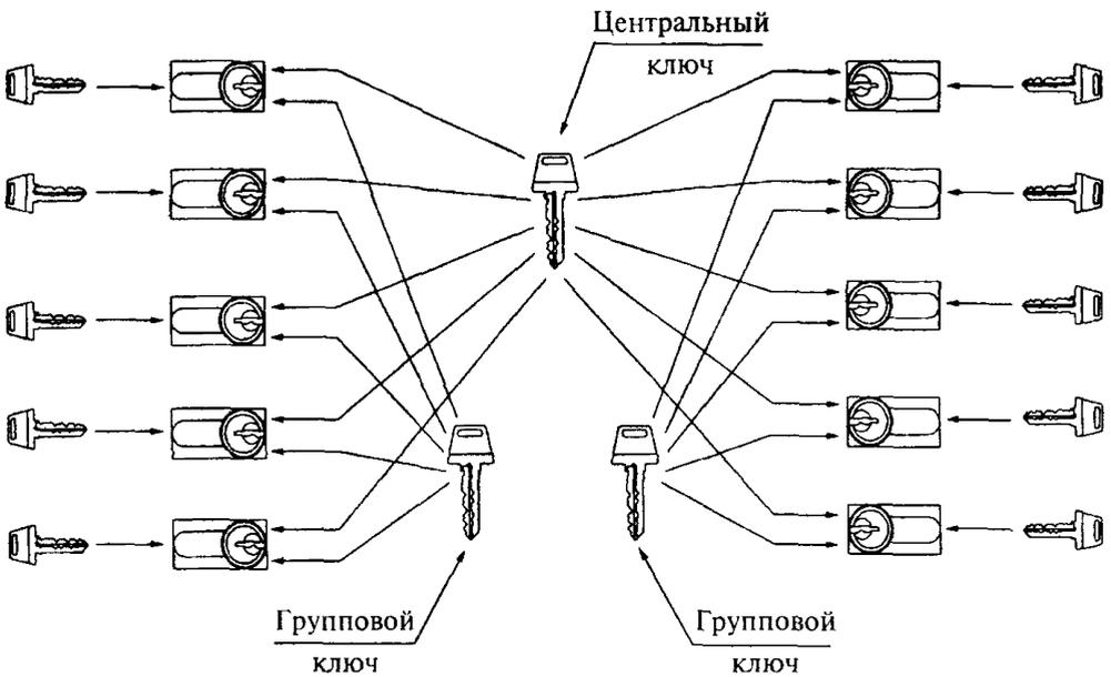
**Рисунок Б.4** — Система цилиндрических механизмов с центральным ключом — набор, состоящий не менее чем из двух систем цилиндрических механизмов с групповым ключом, каждый из которых можно открывать и закрывать центральным ключом, свойственным для всего набора
