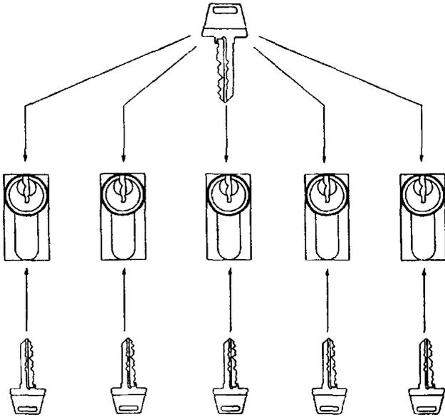
**Рисунок Б.3** — Система цилиндрических механизмов с групповым ключом — группа механизмов, каждый из которых можно открывать и закрывать как собственным ключом, так и групповым ключом, свойственным для данной группы
