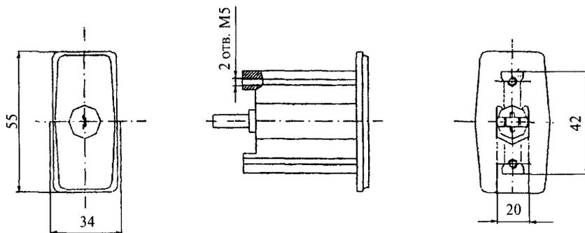
**Рисунок В.31** — Пример механизма цилиндрового штифтового для врезных замков, тип МЦ11
