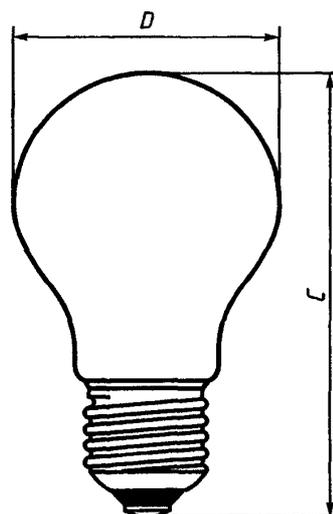
Рисунок 2 — Лампа с резьбовым цоколем Эдисона
