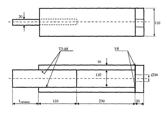
Рис. Б.З. Приспособление для испытания на статический отрыв
