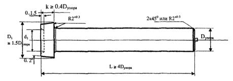
Рис. 3.1. Основные размеры допускаемых к применению в мостостроении «упоров»
