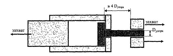
Рис. Б.2.Схема испытаний на статический отрыв
