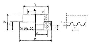
Рис. 3 2. Размеры керамических колец для «упоров», рекомендованных для мостостроения
