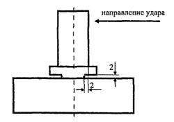
Рис. Б.4. Надрез при испытаниях упора
