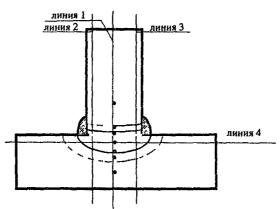
Рис. Б.5. Измерения твёрдости упора
