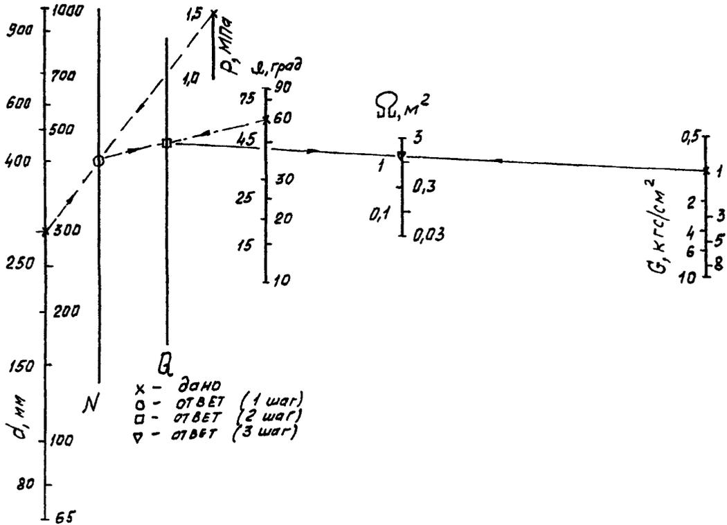
**Рисунок В.1** — Номограмма для выбора опорной площади упоров  $\Omega$  на трубопроводе водоснабжения диаметром  $d$  из труб из высокопрочного чугуна с шаровидным графитом с раструбными соединениями, находящемся под внутренним давлением  $p$ , при угле поворота трассы  $\alpha$  с опорой на грунт прочностью  $G$
