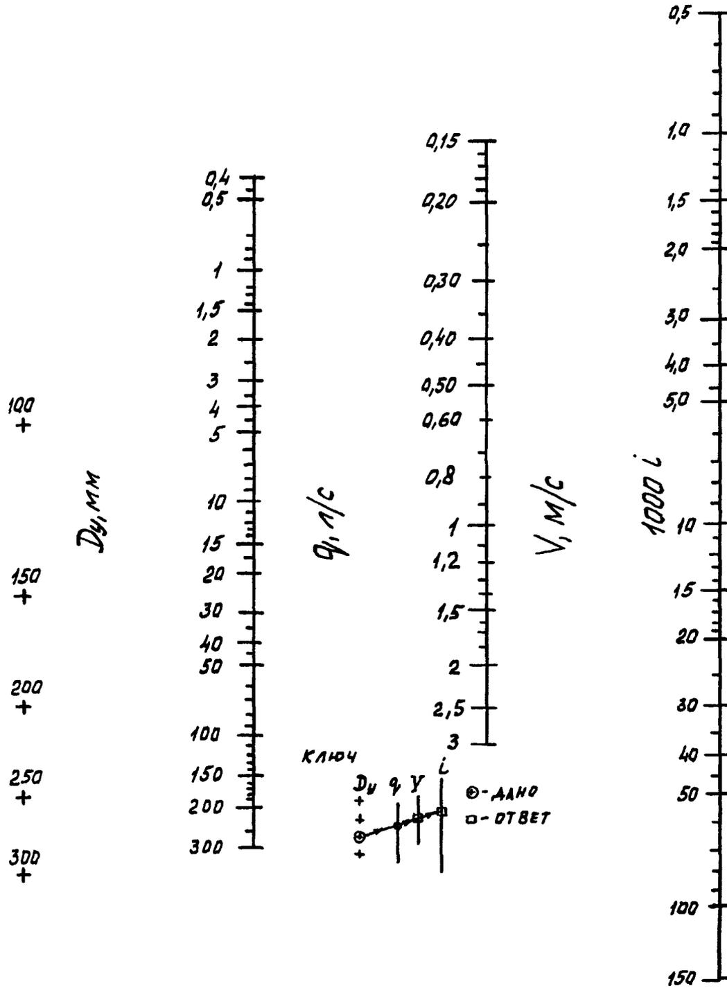
$D_y$  — диаметр условного прохода,  $q$  — расчетный расход воды;  $V$  — средняя по сечению скорость движения воды;  $i$  — гидравлический уклон (потери напора по 3.5.3 на единицу длины трубопровода)
