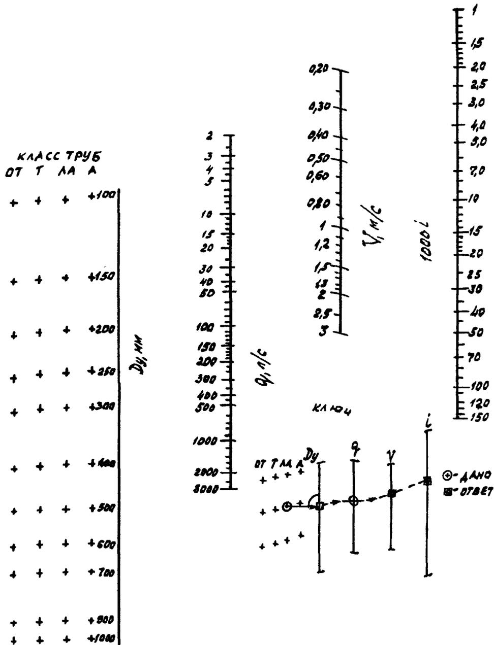
$D_y$  — диаметр условного прохода,  $q$  — расчетный расход воды;  $V$  — средняя по сечению скорость движения воды;  $i$  — гидравлический уклон (потери напора по 3.5.3 на единицу длины трубопровода)
