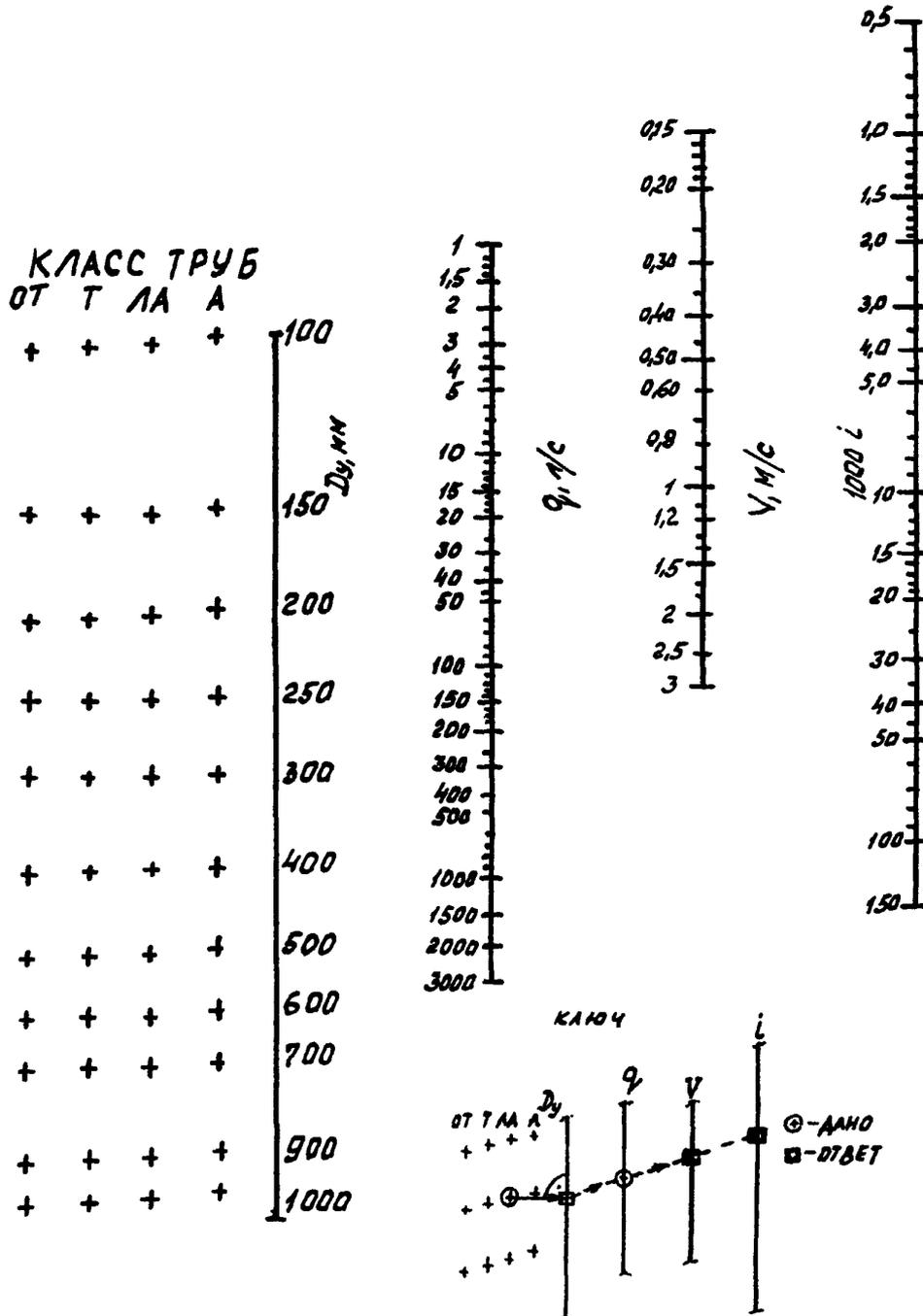
$D_y$  — диаметр условного прохода;  $q$  — расчетный расход воды;  $V$  — средняя по сечению скорость движения воды,  $i$  — гидравлический уклон (потери напора по 3.5.3 на единицу длины трубопровода)
