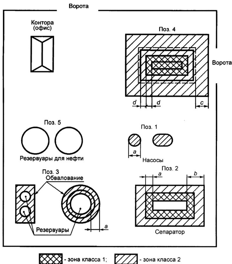
В данном примере использованы примеры 1, 6, 8 и 9 для классификации наружного пространства резервуарного парка для бензина и нефти, на площадке которого установлены пять насосов для жидкости (поз. 1), расположенных вблизи друг от друга, отдельно стоящий насос (поз. 1), один гравитационный сепаратор нефти/воды (поз. 2), три резервуара для хранения бензина (поз. 3), одна установка для заправки автоцистерн (поз. 4), два резервуара для нефти (поз. 5).
