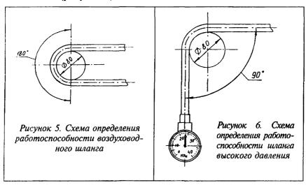
Результат данной проверки считают положительным, если не произошло разрывов, отсутствуют трещины в шлангах. При положительных результатах проверки работоспособности воздуховодного шланга, подключаемого к легочному автомату, и шланга высокого давления, подключаемого к манометру, испытатель начинает выполнять комплекс упражнений.
