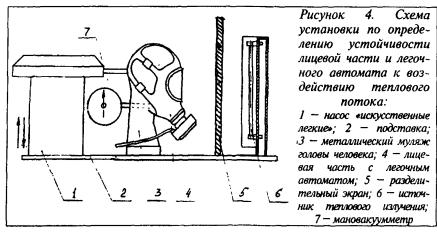
Включают источник теплового потока и с помощью датчика теплового потока определяют место, в котором плотность теплового потока составляет (8,5  $\pm$ 0,5) кВт/м², и отмечают данное место на подставке. Устанавливают на подставку разделительный экран. На отмеченное место ставят муляж головы че-
