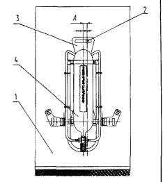
Рисунок 1. Принципиальная схема стенда для определения смещения центра массы: 1 — щит, 2 — штырь, 3 — приспособление, 4 — дыхательный аппарат
