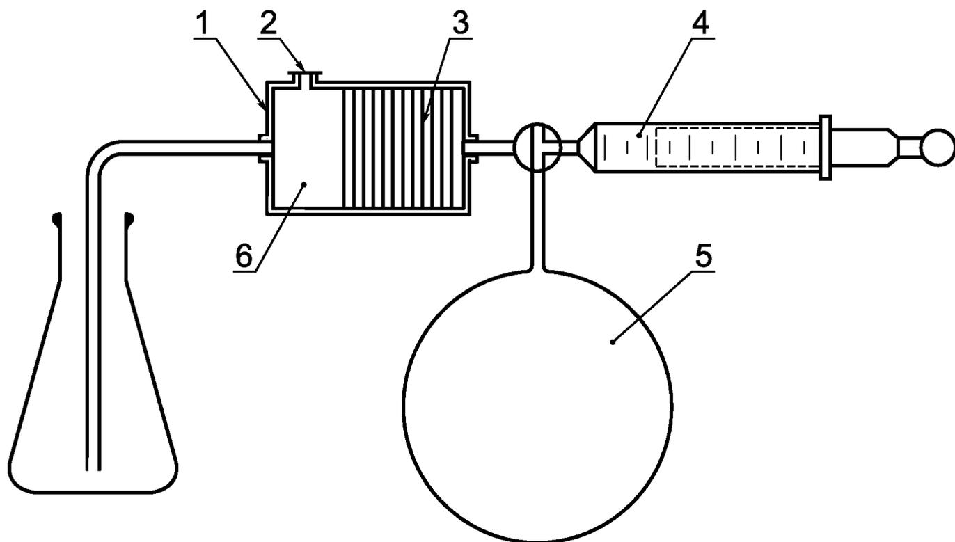
1 — огнепреградитель; 2 — предохранительная мембрана; 3 — пластинки из спеченного стекла (перегородки);
