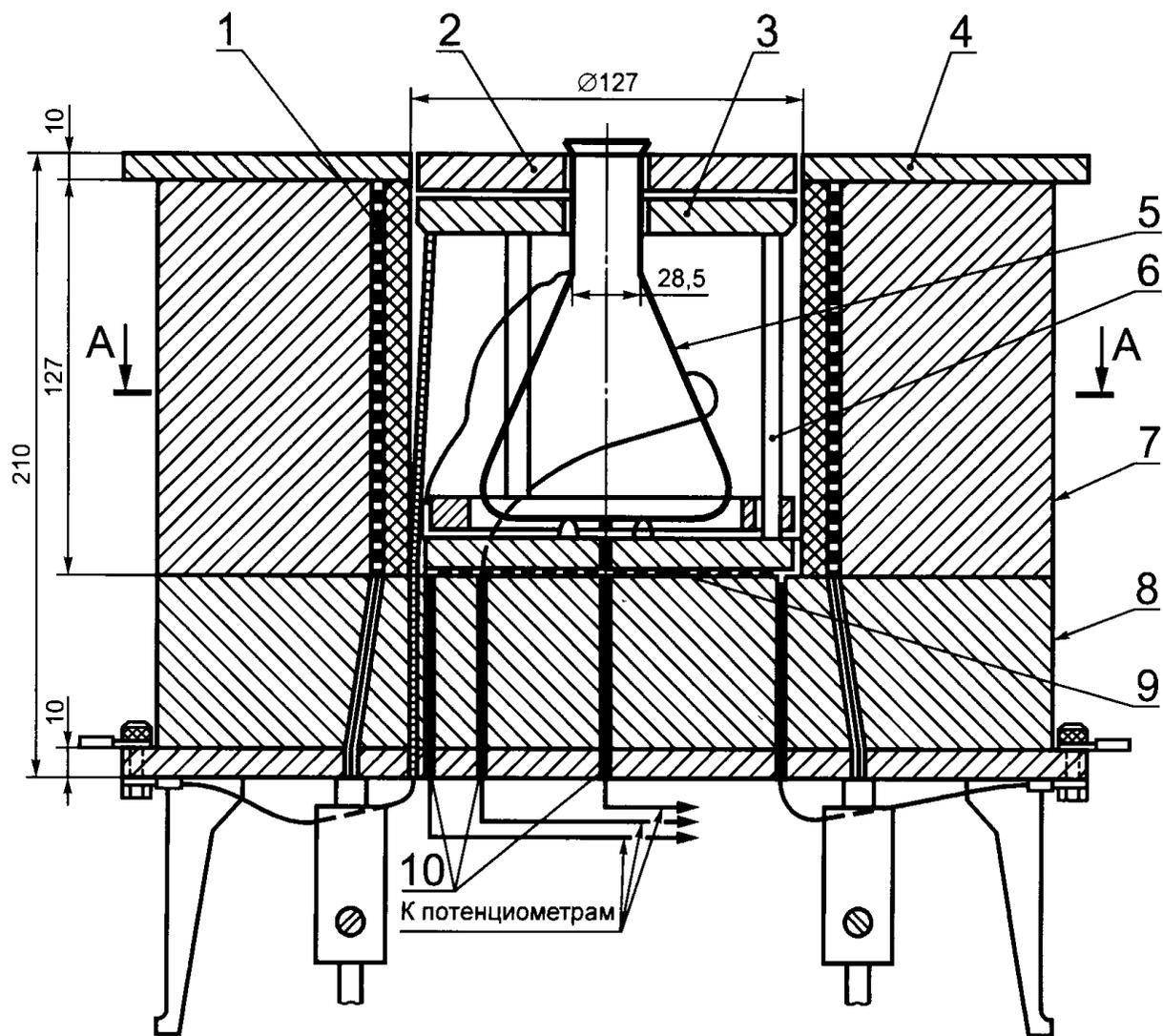
1 — основной нагреватель; 2 — кольцо крышки; 3 — обогреватель горловины; 4 — крышка из огнеупорного материала; 5 — колба вместимостью 200 см<sup>3</sup>; 6 — керамическая опора; 7 — поддерживающий цилиндр; 8 — электрический тигель печи; 9 — основной нагреватель; 10 — термопары
