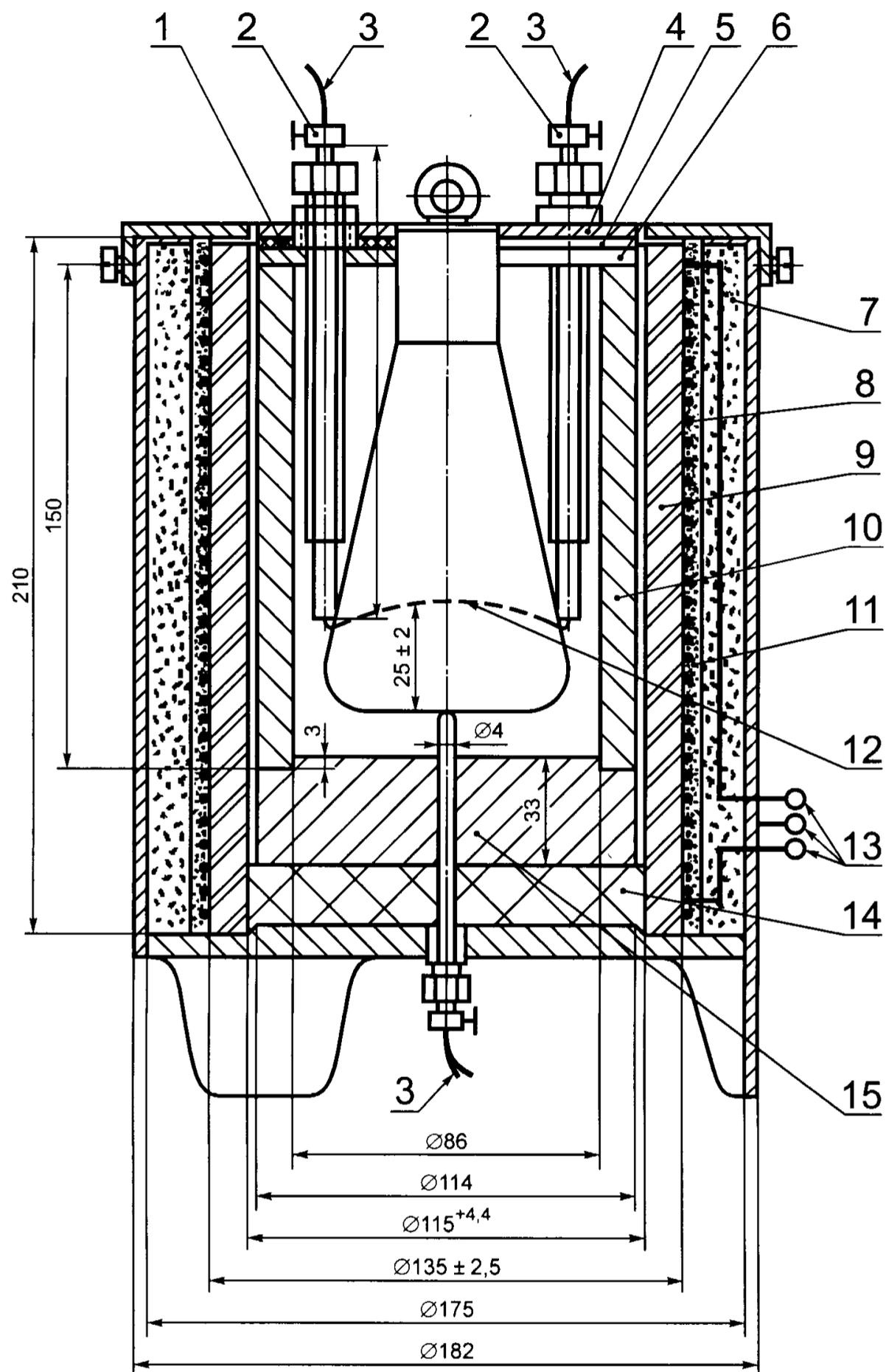
1 — высокотемпературная изоляция; 2 — зажимные втулки; 3 — термопары; 4 — верхняя часть крышки; 5 — изоляционное кольцо; 6 — нижняя часть крышки; 7 — теплоизоляция; 8 — нагреватель; 9 — керамическая трубка; 10 — стальной цилиндр; 11 — высокотемпературная мастика; 12 — контрольные точки; 13 — соединение нагревателя на напряжение 220 В; 14 — изоляционный диск; 15 — металлическое основание
