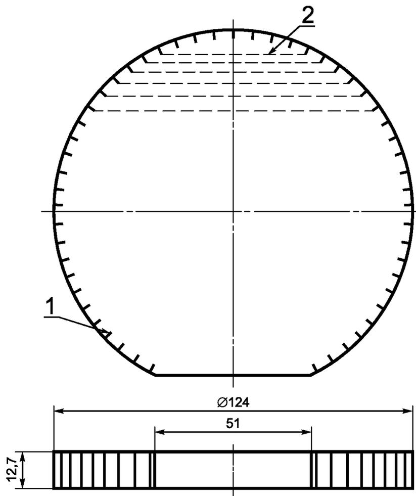
1 — паз размером 1,5·1,5 мм на боковой поверхности диска;
