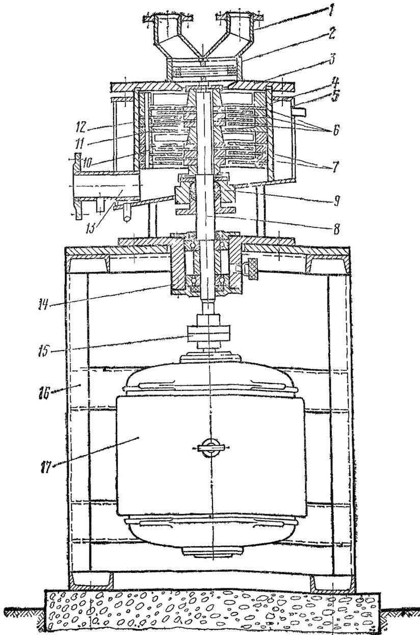
Рис. 1 Схема устройства многодискового диспергатора ЭМ-25.
