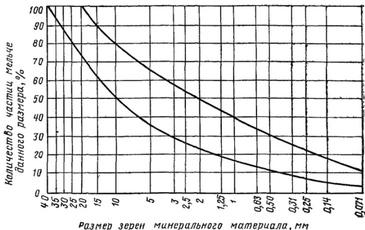
Рис. 5. Кривые зернового состава плотных гравийных смесей
