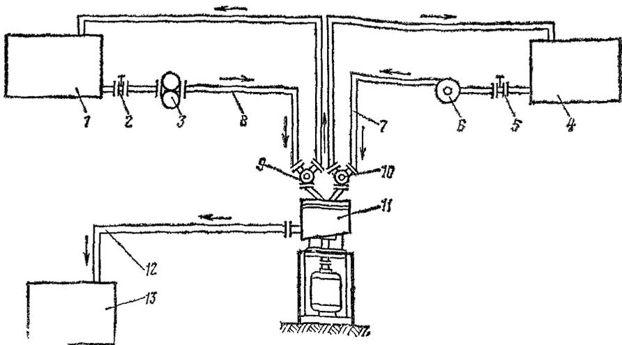
Рис 2 Схема подключения многодискового диспергатора ЭМ-25
