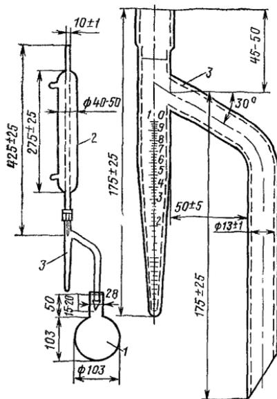
Рис 1. Прибор Дина-Старка для определения содержания воды
