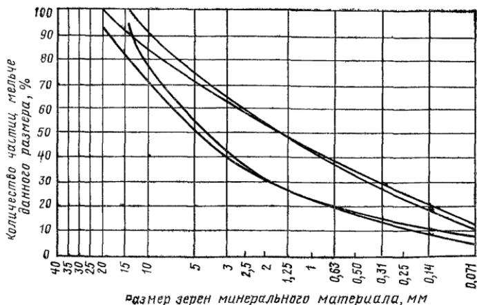
Рис 4 Кривые зернового состава плотных щебеночных смесей
