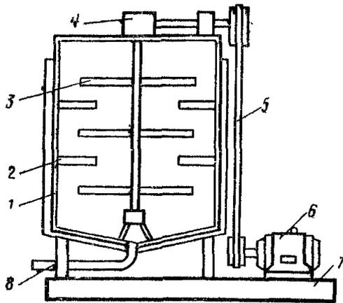
Рис. 5. Мешалка для приготовления обратных эмульсий:
