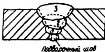
Рис. 5.16. Расположение слоев (валиков) при сварке стыков трубопроводов со стенкой толщиной 12–14 мм:
