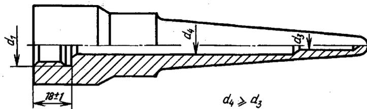
$d_1$  — присоединительная резьба для термометра или термопреобразователя;  $d_2$  — присоединительная резьба гильзы;
