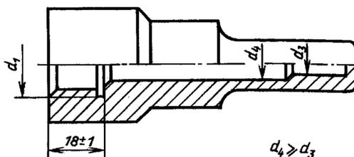
$d_1$  — присоединительная резьба для термометра или термопреобразователя;  $d_2$  — присоединительная резьба гильзы;
