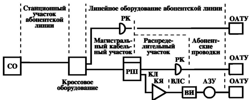
СО — станционное оборудование; ВЛС — воздушная линия связи; КЛ — кабельная линия; РПШ — кабельный распределительный шкаф; РК — абонентская распределительная коробка; КЯ — телефонный кабельный ящик; ВИ — вводные изоляторы; АЗУ — абонентское защитное устройство; ОАТУ — оконечное абонентское телефонное устройство; — место стыка
