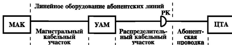
МАК — модуль абонентской концентрации; УАМ — удаленный абонентский модуль; ЦТА — цифровой телефонный аппарат; РК — абонентская распределительная коробка; — место стыка
