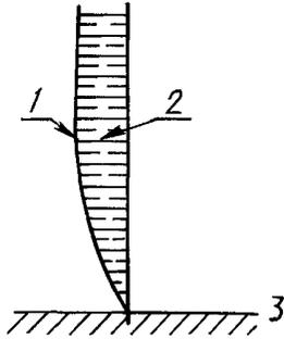
1 — криволинейная поверхность отвала; 2 — объем, прилегающий к криволинейной поверхности отвала; 3 — опорная плоскость отсчета (GRP)
