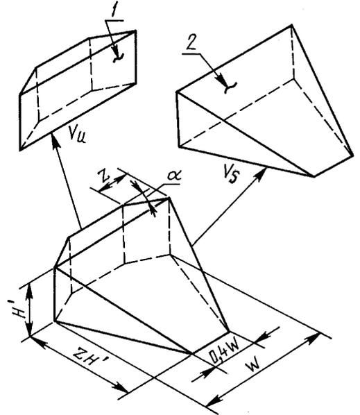
$1$  — эффективный контур полусферического и сферического отвалов;  $2$  — прямой и поворотный отвалы
