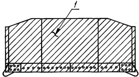
1 — площадь проекции  $A_m$  (прямой, полусферический и сферический отвала)
