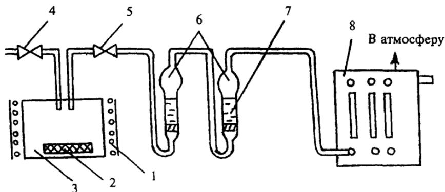
1 — воздушный термостат; 2 — образец теплоизоляционного изделия; 3 — герметичная испытательная камера; 4, 5 — вакуумные краны; 6 — поглотительные сосуды; 7 — поглотительная жидкость; 8 — аспиратор
