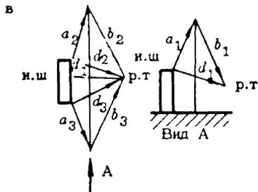
Рис. П.4.4. Расчетные схемы для определения эффективности экранирования шума: а - здание; б - откосом выемки, в - стенкой в случае крупноразмерного источника шума
