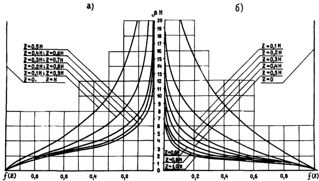
Рис.2. График для определения  $f(z)$  при двустороннем (а) и одностороннем (б) отводе воды из дрены
