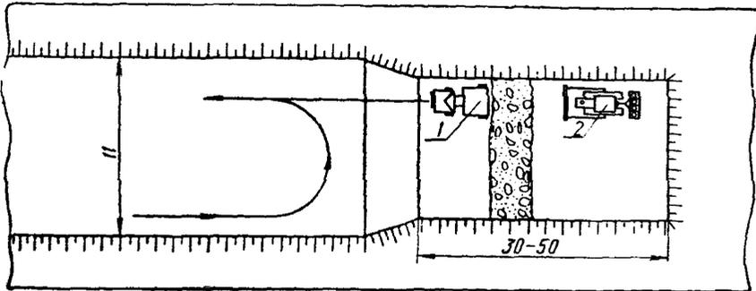
Рис. 25. Схема отсыпки верхних слоев насыпи шириной менее 11 м:
