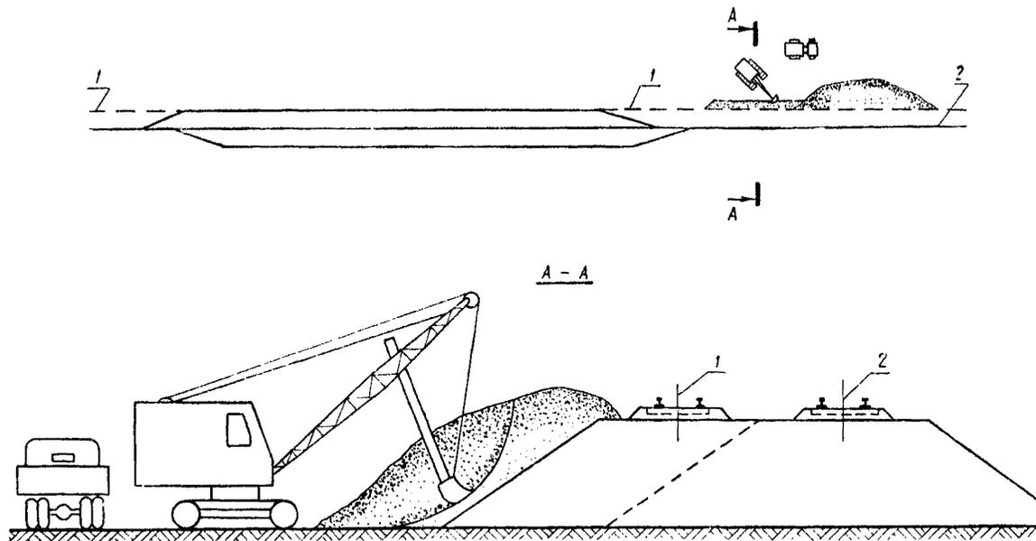
Рис. 79. Перегрузочный карьер дренирующего грунта на раздельном пункте:
