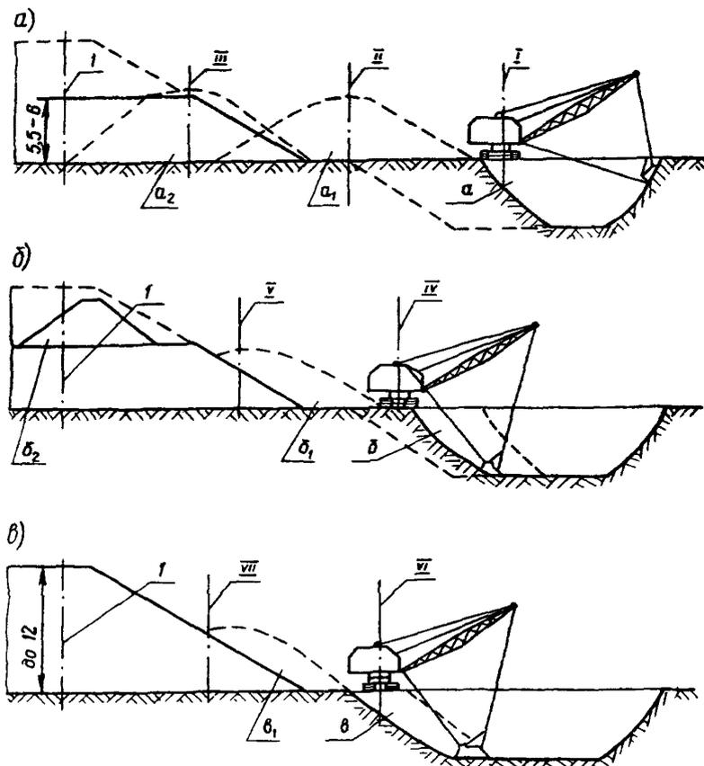
Рис. 65. Схема возведения высокой насыпи драглайном из резервов:
