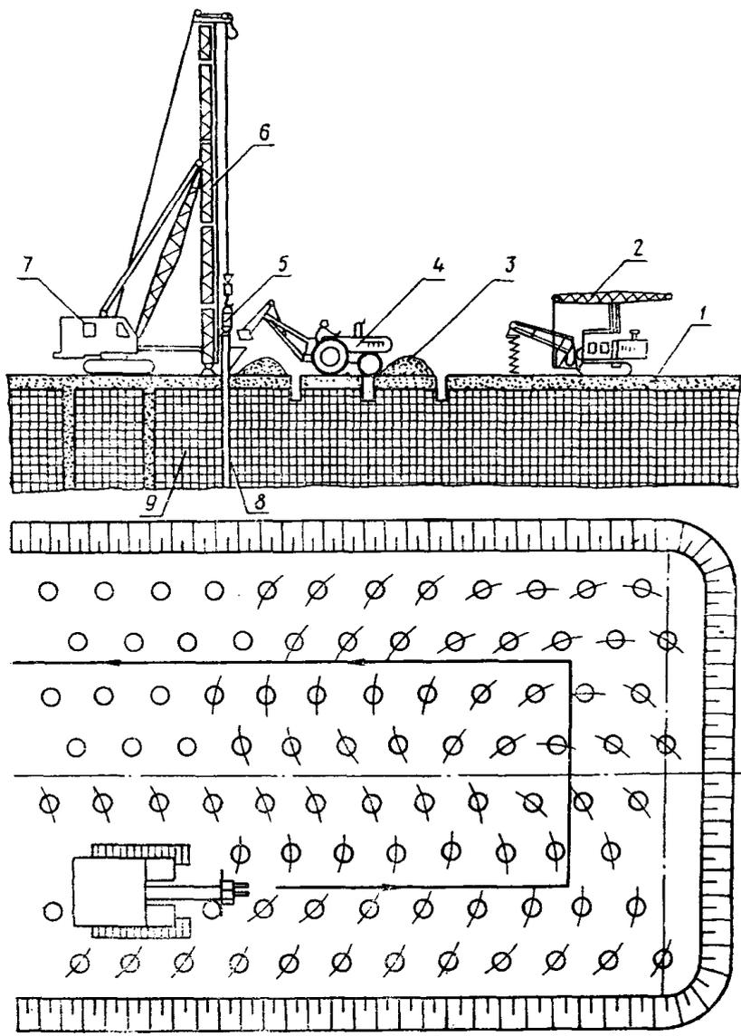
Рис. 60. Технологическая схема устройства вертикальных песчаных дрен:
