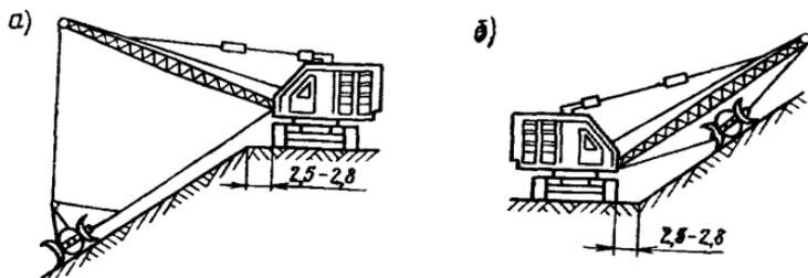
Рис. 100. Планировка откосов экскаватором с двухотвальным планировщиком:
