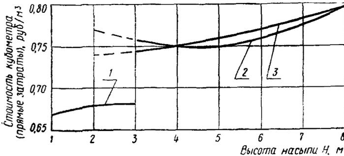
1—однополосная схема; 2—двухполосная схема, автосамосвалы грузоподъемностью 7 т; 3—то же 4,5 т; ———— —рекомендуемая область применения схем
