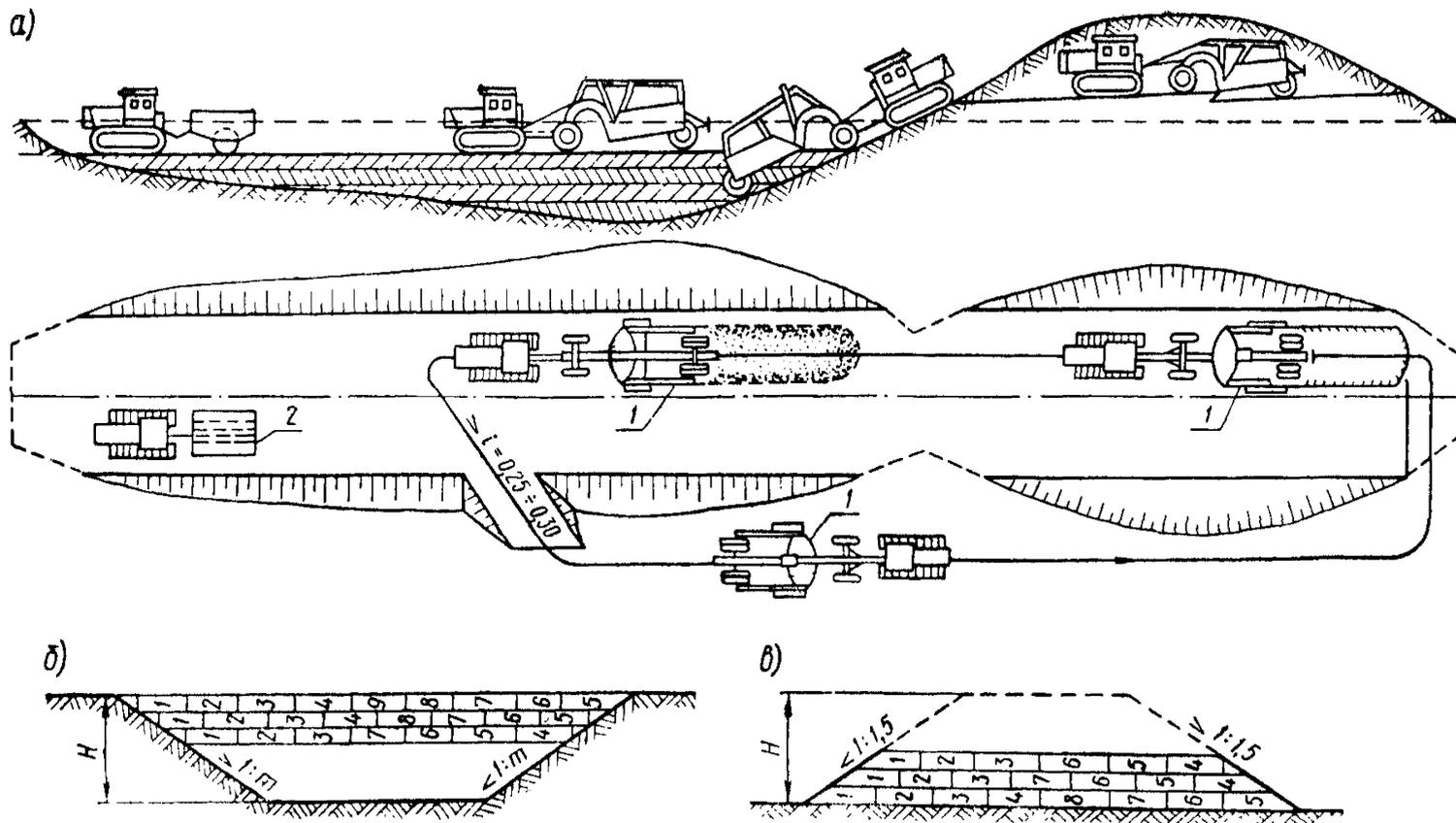
Рис. 38. Схема разработки выемки скреперами с перемещением и укладкой грунта в насыпь:
