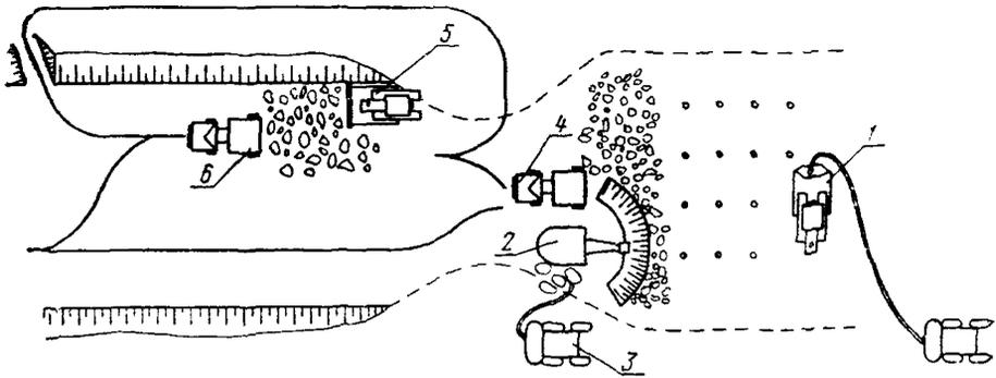
Рис. 34. Схема лобовой разработки скальной выемки экскаватором-прямой лопатой:
