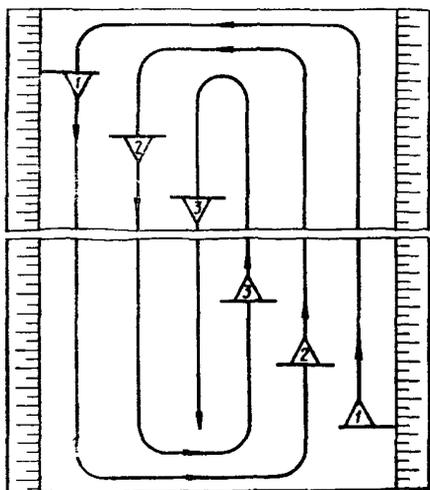
Рис. 87. Технологическая схема уплотнения насыпи грунтоуплотняющей машиной, включая бровочные части:
