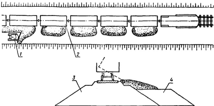
Рис. 78. Отсыпка насыпи дренирующим грунтом с действующего пути:
