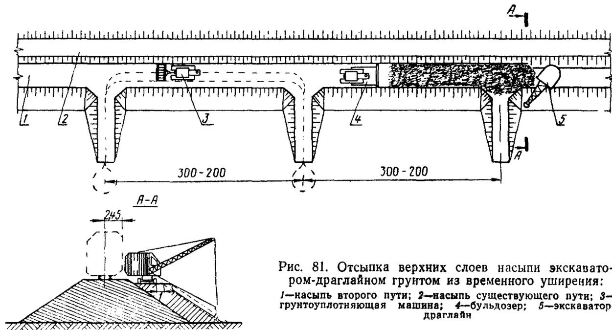
Рис. 81. Отсыпка верхних слоев насыпи экскаватором-драглайном грунтом из временного уширения:
