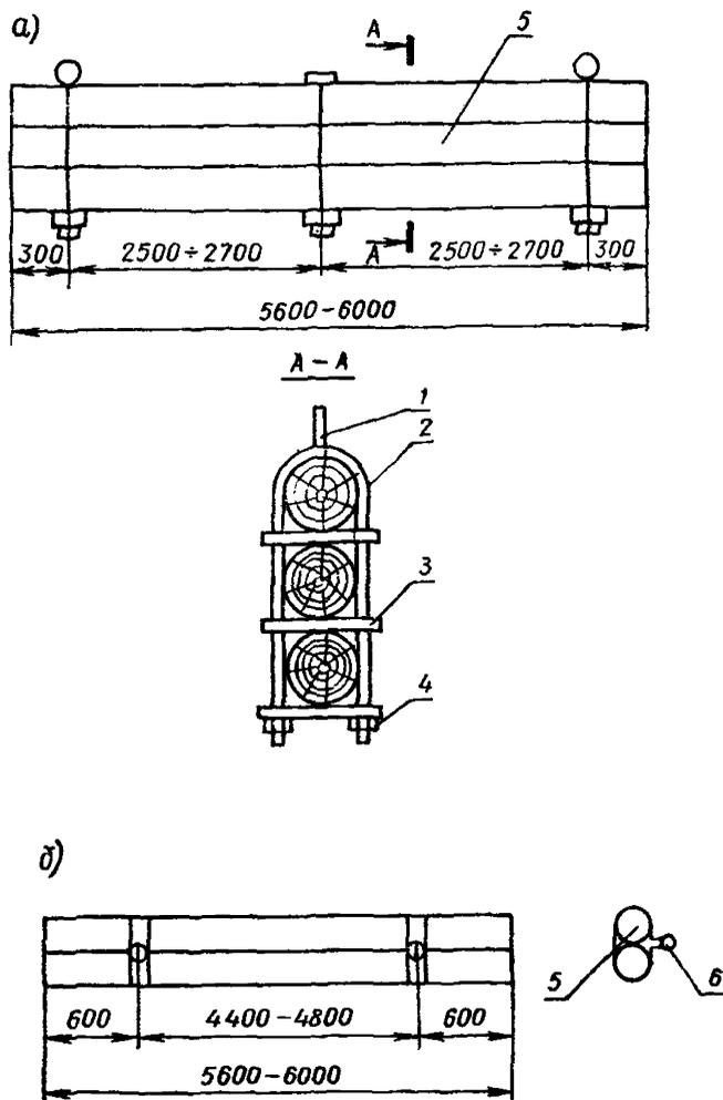
Рис. 55. Конструкции деревянных переносных щитов (размеры, мм):
