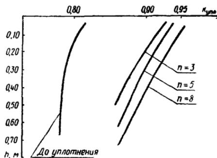
Рис. 91. График пробного уплотнения грунта
