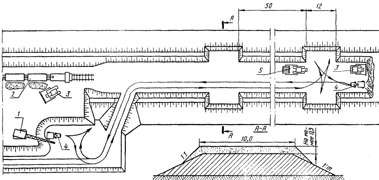
Рис. 64. Схема отсыпки первого слоя песчаной подушки из перегрузочного карьера:
