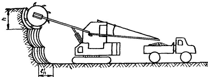
Рис. 30. Схема разработки забоя роторным экскаватором вертикальными стружками
