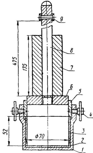
Рис. 2. Схема прибора ЦНИИСа для стандартного уплотнения грунтов:
