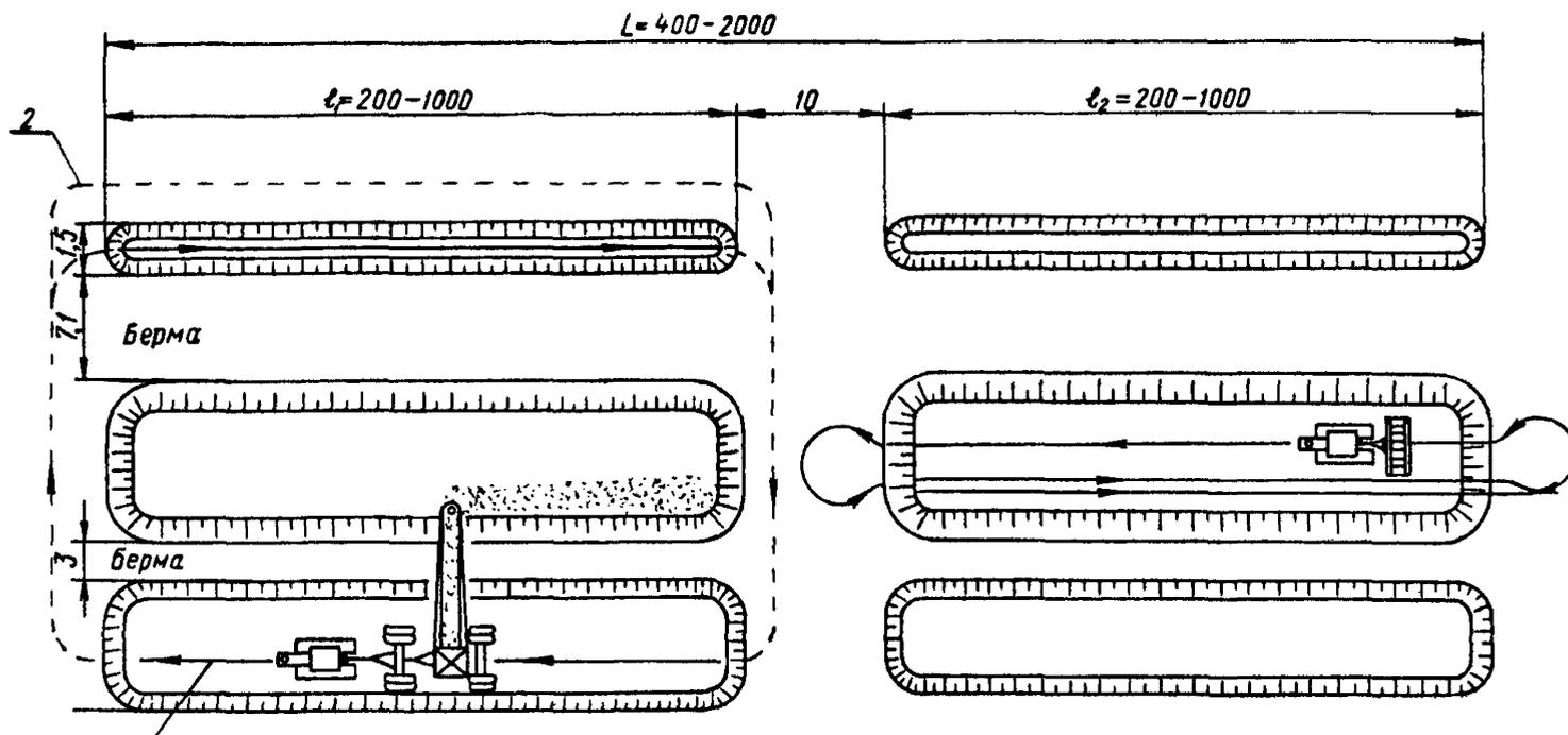
Рис. 48. Схема возведения насыпи грейдер-элеватором из резерва:
