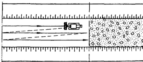
Рис. 89. Челночная схема уплотнения грунта дизель-трамбовочной машиной
