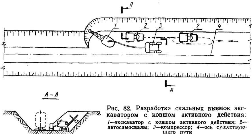
Рис. 82. Разработка скальных выемок экскаватором с ковшом активного действия: 1—экскаватор с ковшом активного действия; 2—автосамосвалы; 3—компрессор; 4—ось существующего пути
