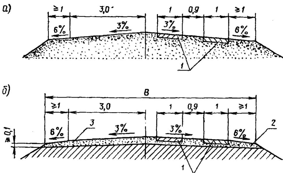
Рис. 6. Типовые поперечные профили колейного покрытия из железобетонных плит на двухполосных дорогах:
