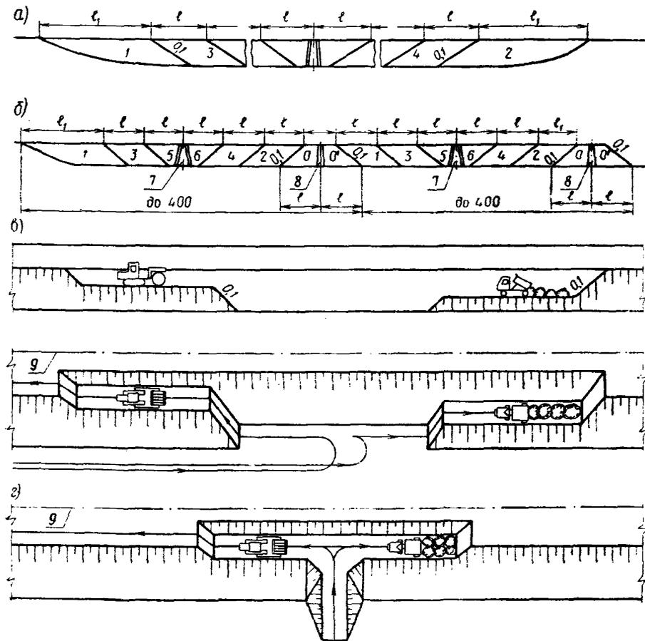
Рис. 71. Отсыпка насыпи с однополосным ведением работ:
