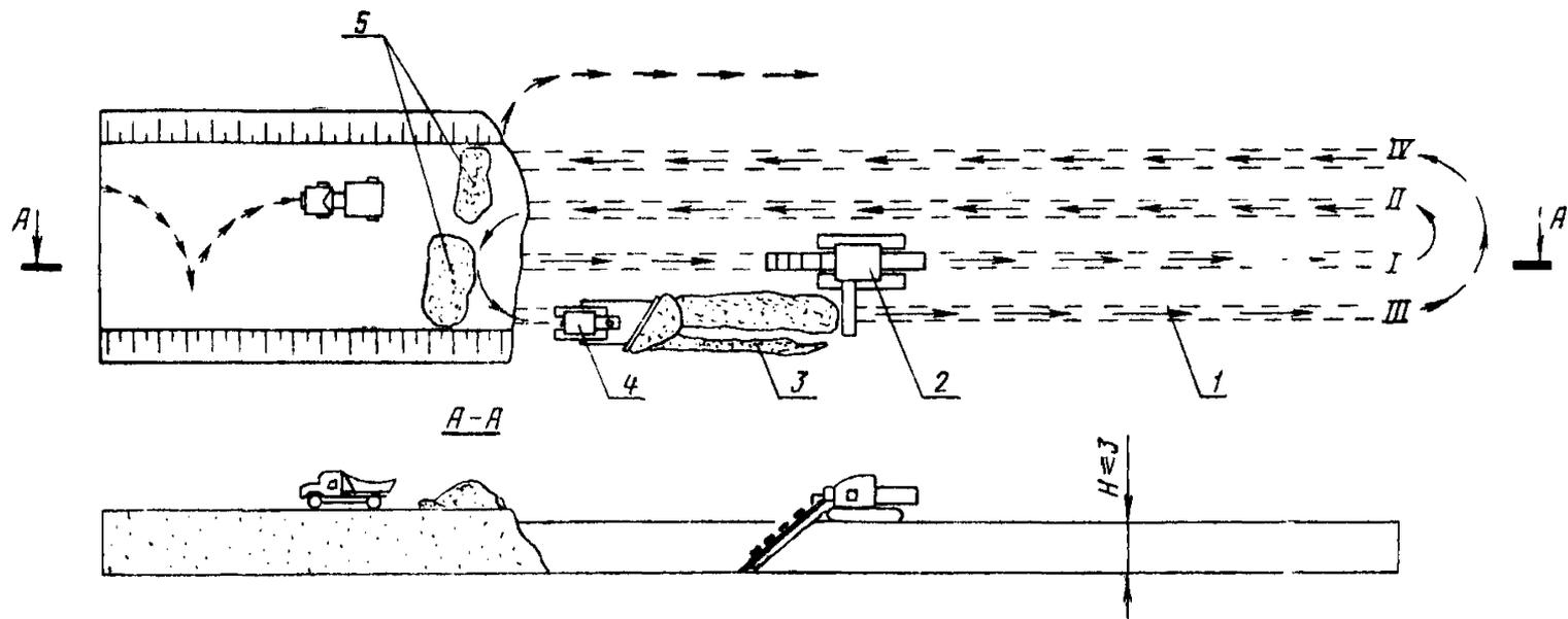
Рис. 59. Схема организации работ по устройству прорезей многоковшовым экскаватором:
