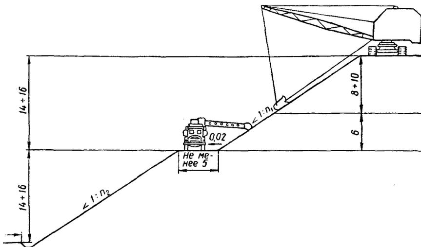
Рис. 107. Схема разравнивания растительного грунта на откосах земляного полотна при рабочих отметках выемок свыше 12 м
