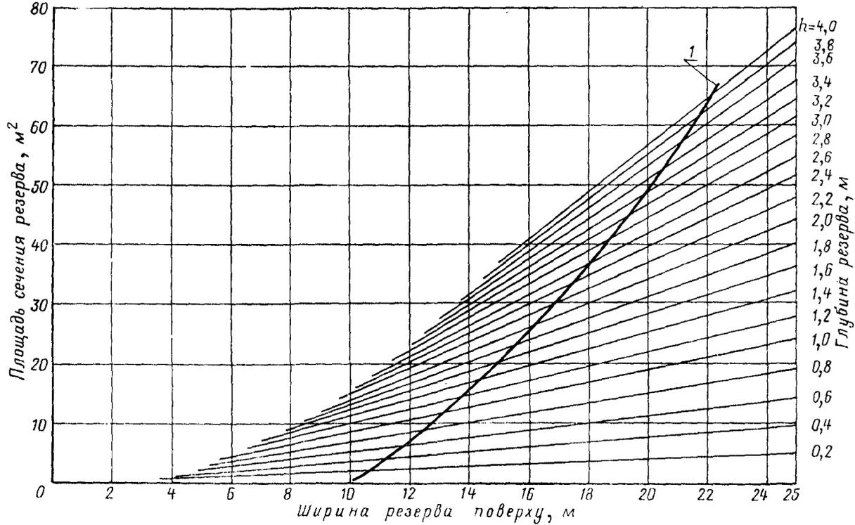
Номограмма для определения площади поперечного сечения резервов:
