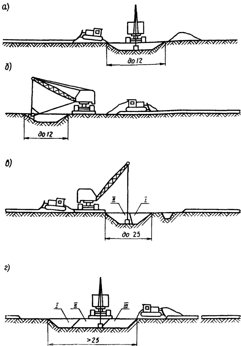
Рис. 56. Схемы разработки траншей:
