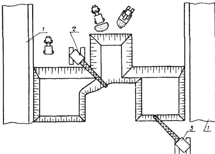
Рис. 57. Схема разработки траншеи при размещении экскаватора на отсыпаемой насыпи:
