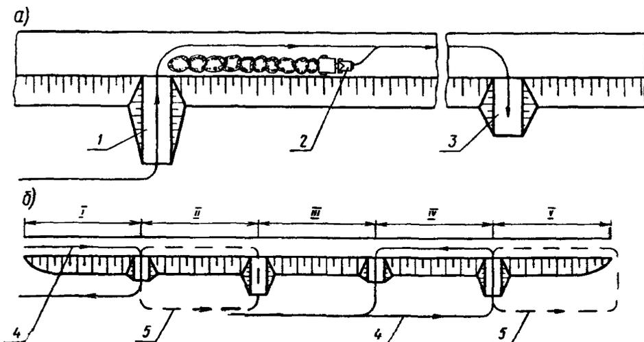
Рис. 72. Отсыпка насыпи с двухполосным ведением работ:
