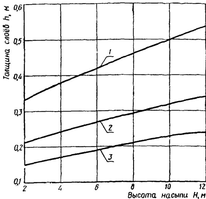
Рис. 2. График зависимости оптимальной толщины отсыпаемого слоя от высоты насыпи и стоимости срезки грунта с откоса  $C_2$  с учетом потерь грунта при срезке:
