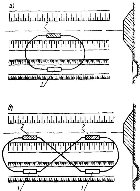
Рис. 40. Схемы движения скрепера:
