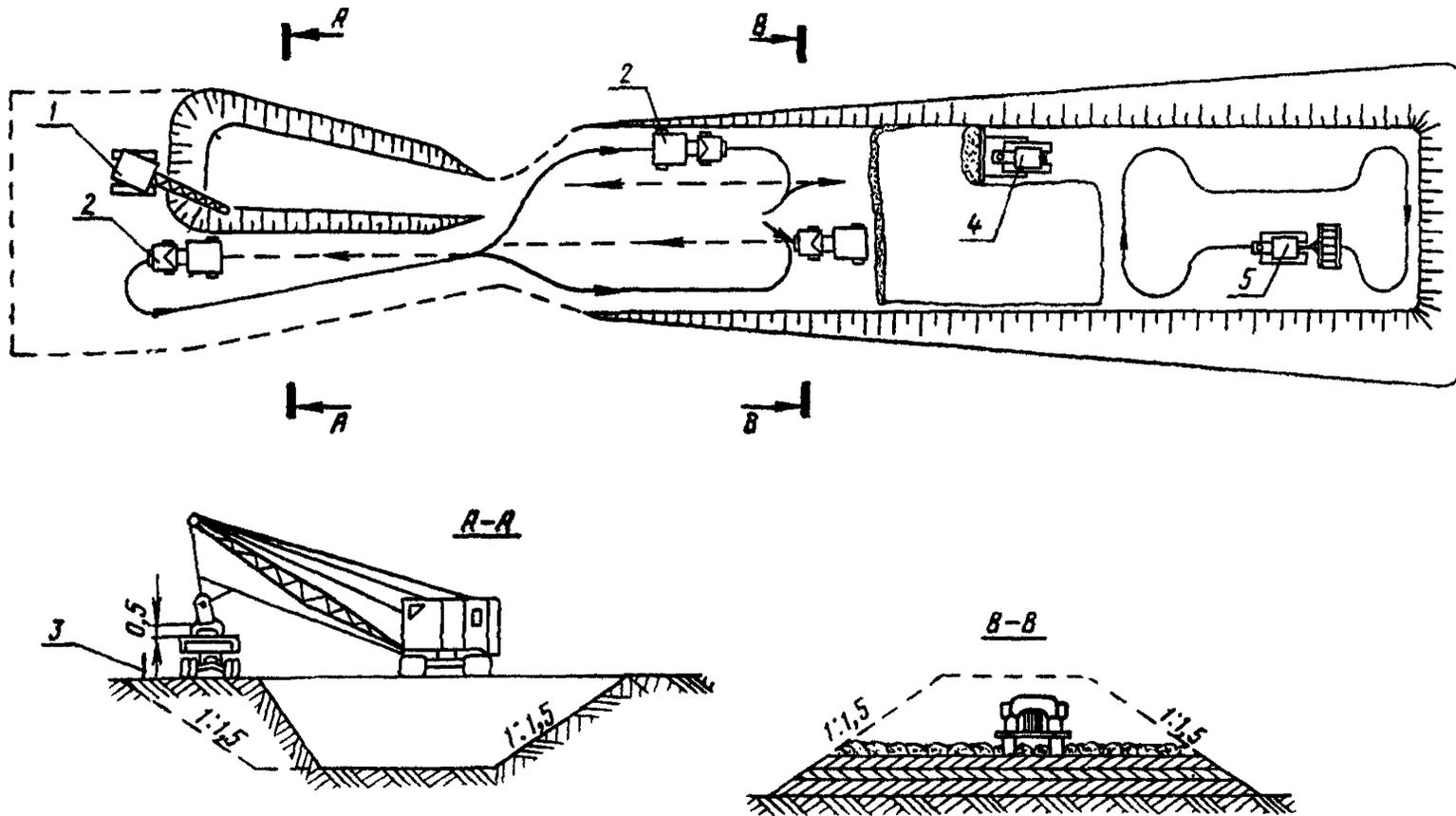
Рис. 24. Схема разработки грунта драглайном и отсыпка насыпи с разворотом автосамосвалов на насыпи:
