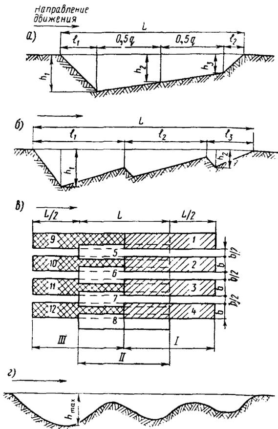
Рис. 39. Схемы резания грунта скреперами:
