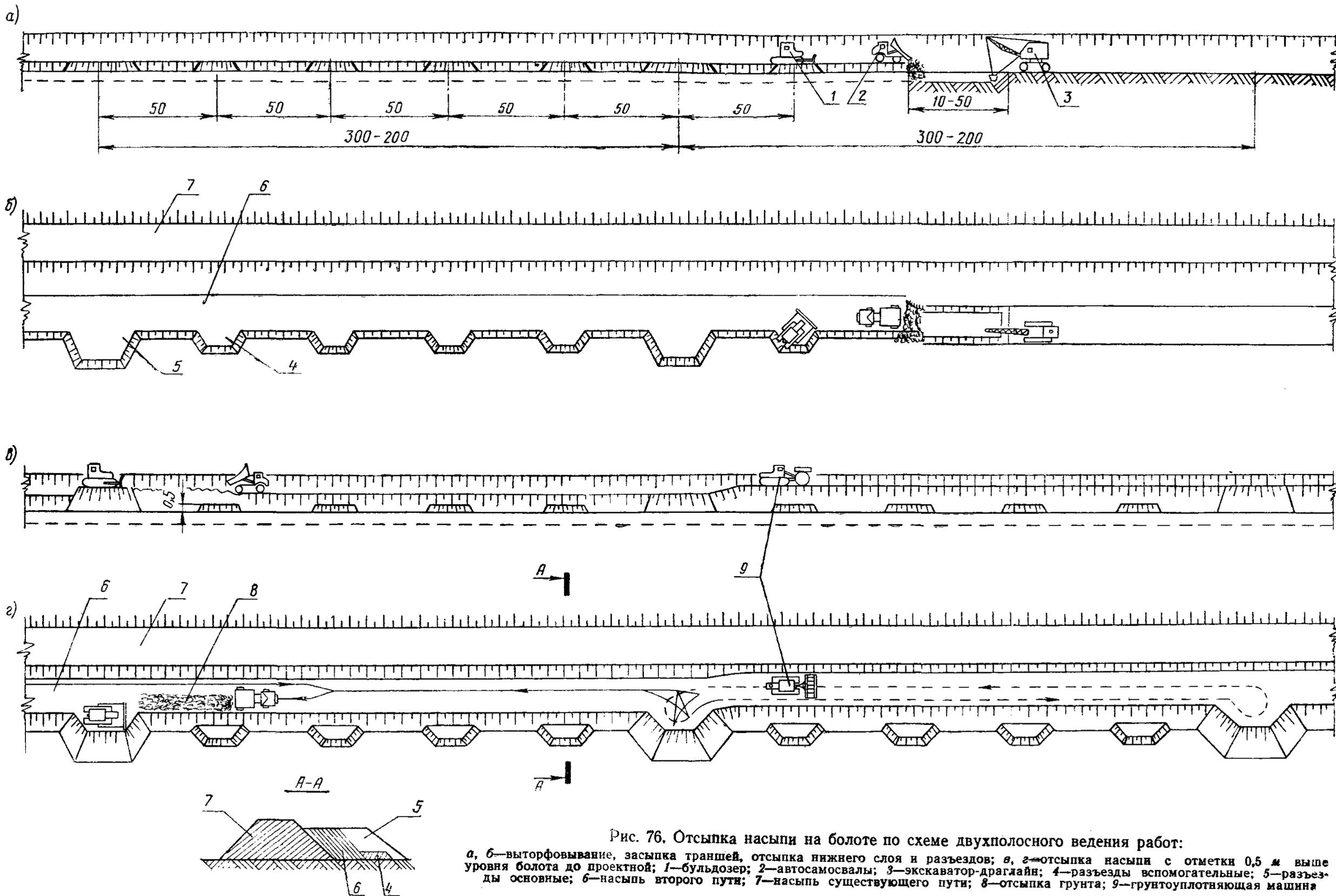
Рис. 76. Отсыпка насыпи на болоте по схеме двухполосного ведения работ:
