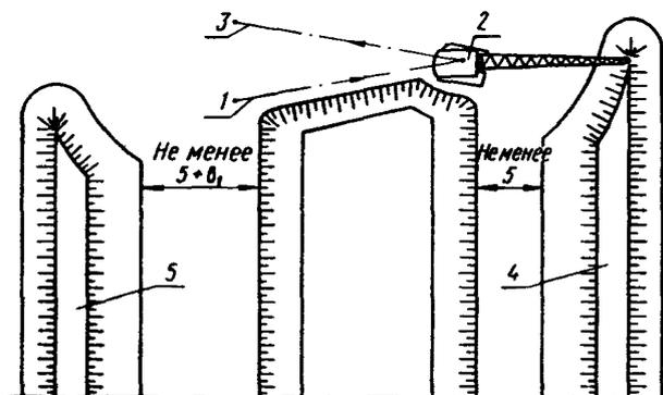
Рис. 18. Схема разработки выемки драглайном уширенными проходками:
