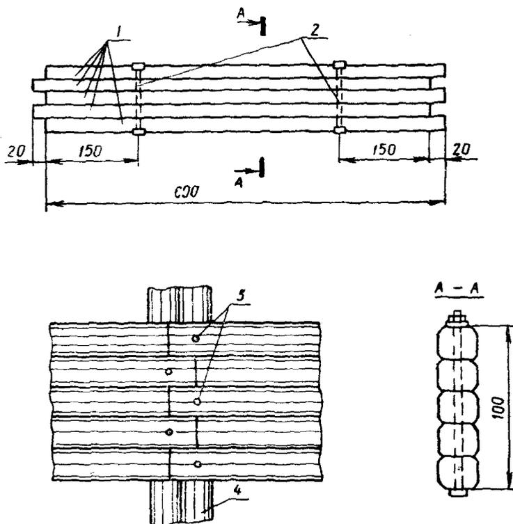
Рис. 8. Конструкция щита дерево-грунтового покрытия автомобильных дорог:
