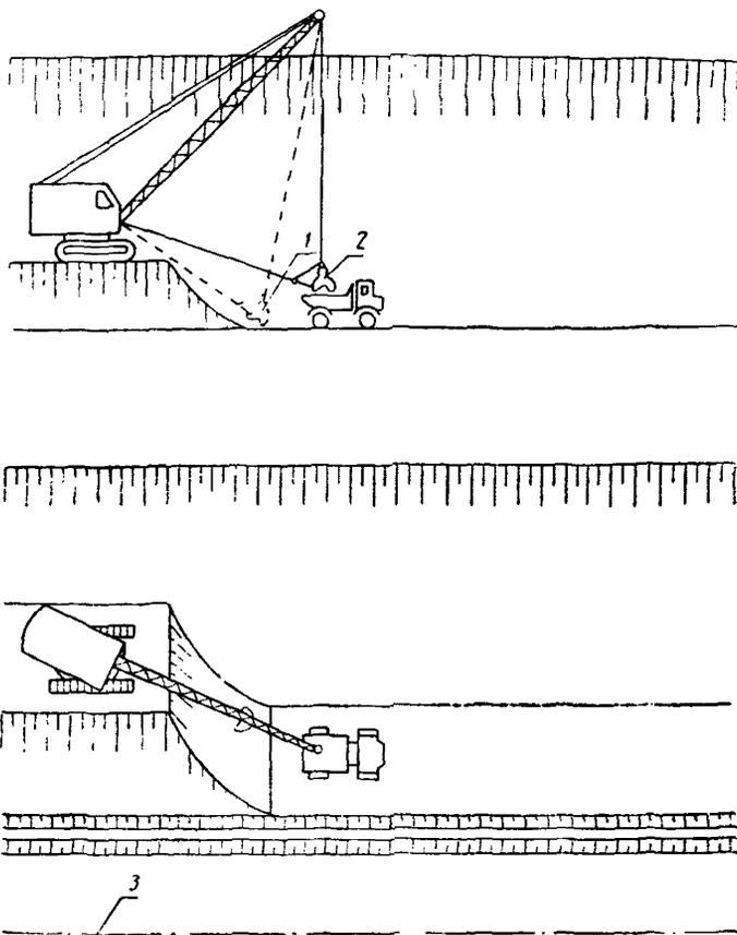
Рис. 70. Разработка выемки второго пути продольно-челночным способом:
