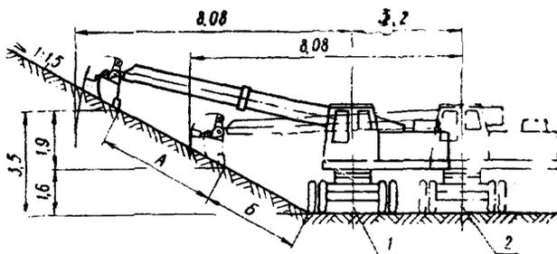
Рис. 102. Планировка откосов с нижней стоянки экскаватором-планировщиком ЭО-3332
