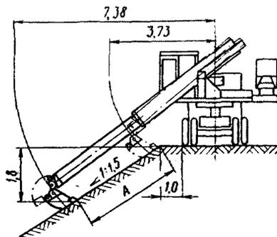
Рис. 101. Планировка откосов с верхней стоянки экскаватором-планировщиком Э-4010:
