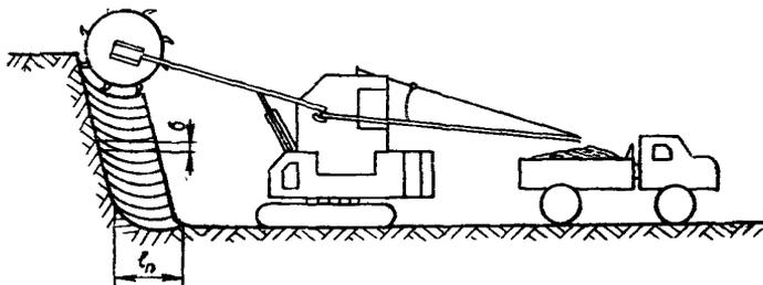
Рис. 29. Схема разработки забоя роторным экскаватором горизонтальными стружками
