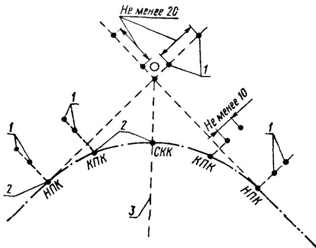
Рис. 5. Закрепление оси пути на кривой выносными столбами:
