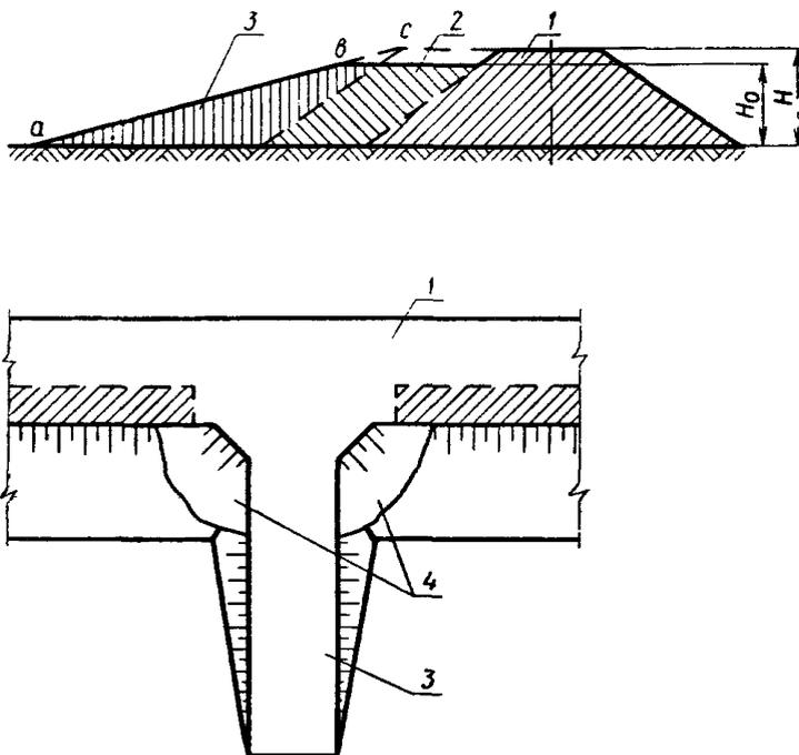
Рис. 74. Размещение запаса грунта для досыпки въезда (съезда):
