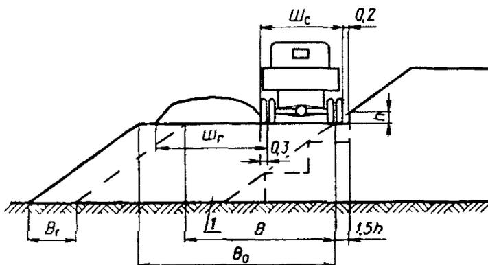
Рис. 67. Двухполосное возведение насыпи:
