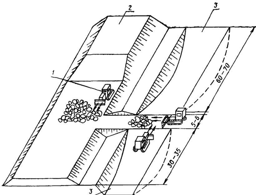
Рис. 66. Схема сооружения земляного полотна комплексом из трех бульдозеров:
