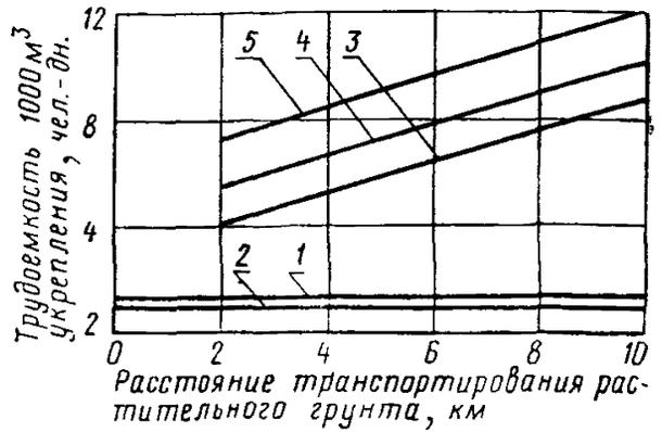
1—гидропосев; 2—гидропосев с уложенного пути; 3—гидропосев по растительному грунту на откосах земляного полотна с рабочими отметками до 3,5 м; 4—механизированный посев трав по растительному грунту на откосах земляного полотна с рабочими отметками от 3,5 до 8 м; 5—то же с рабочими отметками более 8 м
