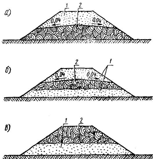
Рис 1. Схемы допустимого расположения грунтов в теле насыпи:
