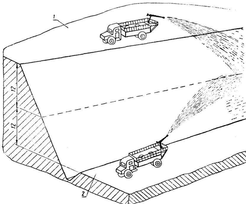
Рис. 105. Укрепление откосов выемки гидросеивом:
