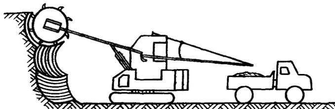
Рис. 31. Схема разработки забоя роторным экскаватором комбинированным способом
