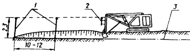
Рис. 14. Устройство водоотвода экскаватором Э-304 с профилировочным ковшом:
