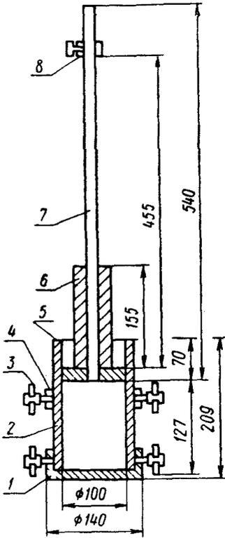
Рис. 1. Схема прибора Союздорнии для стандартного уплотнения грунтов:
