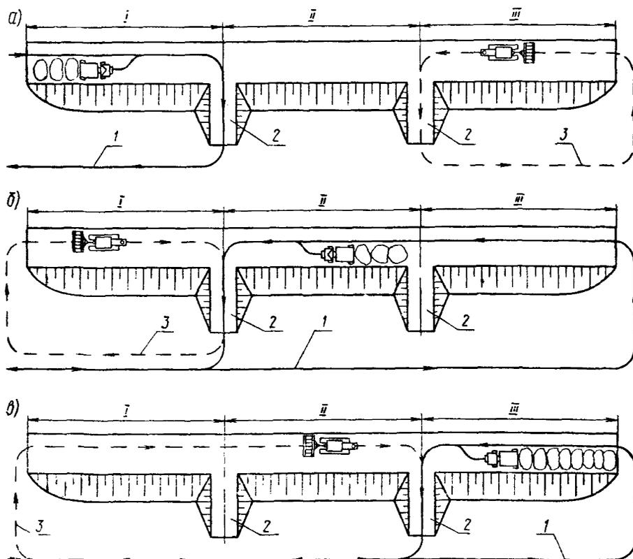
Рис. 73. Возведение насыпи высотой более 6 м:
