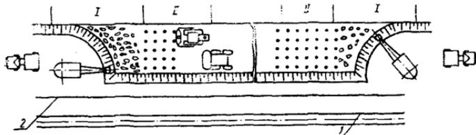
Рис. 83. Схема разработки выемки с двух концов:
