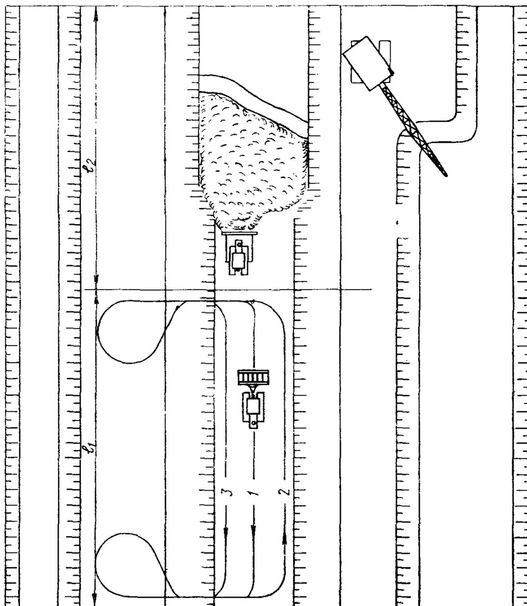
Рис. 19. Схема отсыпки насыпи драглайном из резервов:
