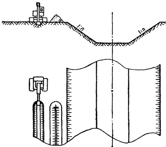
Рис. 10. Технологическая схема разработки нагорной канавы экскаватором-планировщиком
