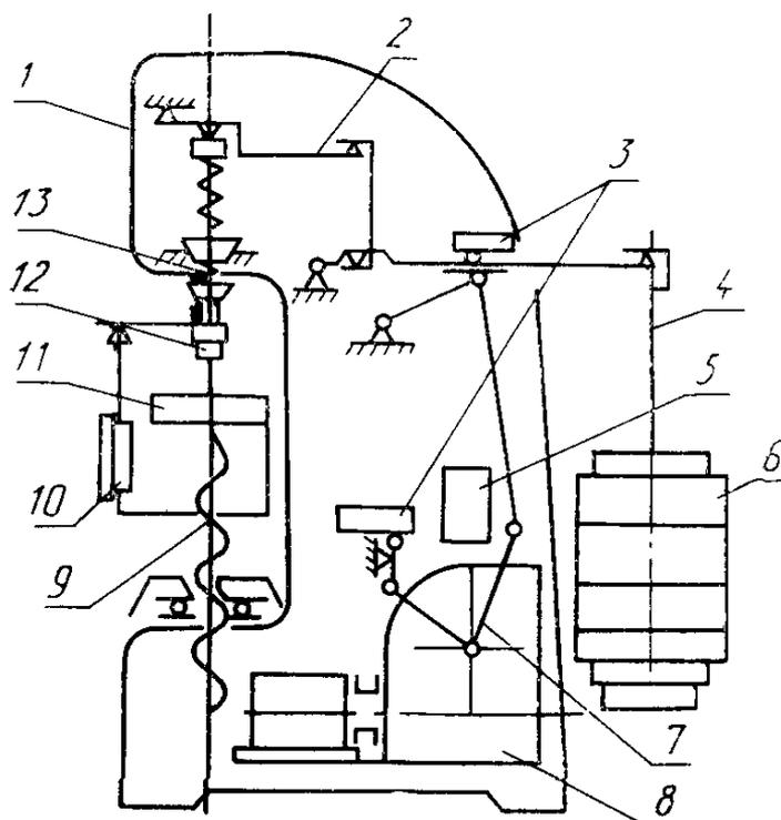
1 — корпус; 2 — рычажная система; 3 — микропереключатель; 4 — подвеска; 5 — блок управления; 6 — сменные грузы; 7 — рычаги привода; 8 — редуктор; 9 — винт; 10 — индикатор; 11 — стол; 12 — индентор; 13 — пружина предварительной нагрузки
