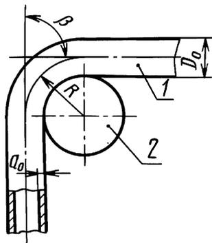
1 — образец-патрубок; 2 — цилиндрическая оправка;
