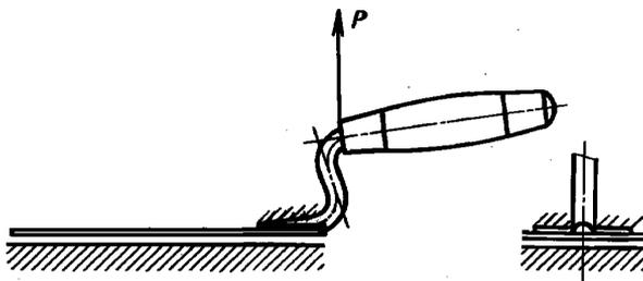
4.6. Сопротивление прокручиванию ручки и прочность соединения ручки с кронштейном (п. 2.10) проверяют на специальных приспособлениях при помощи динамометра общего применения 2-го класса точности методом статической нагрузки в течение 2 мин. При проверке изделий на прочность соединения ручки с кронштейном нагрузка должна быть приложена вдоль оси ручки.
