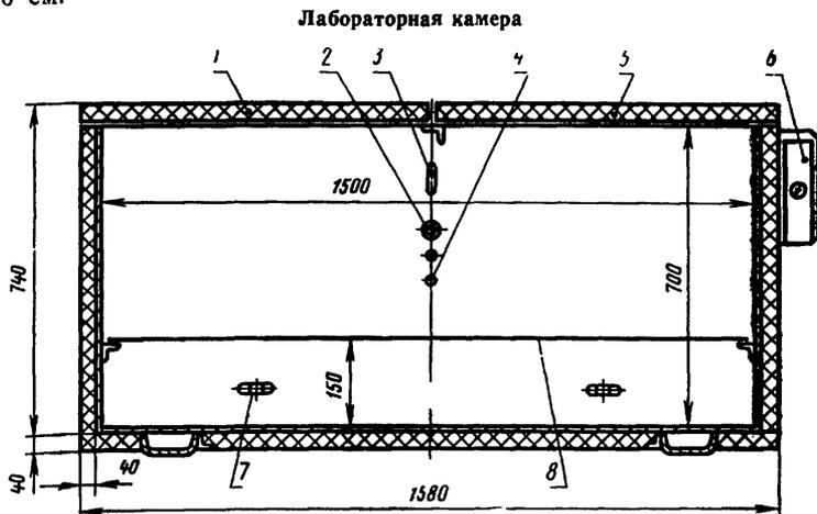
1; 5 — крышки; 2 — защитный стержень датчика температуры; 3 — ввод термометра;
