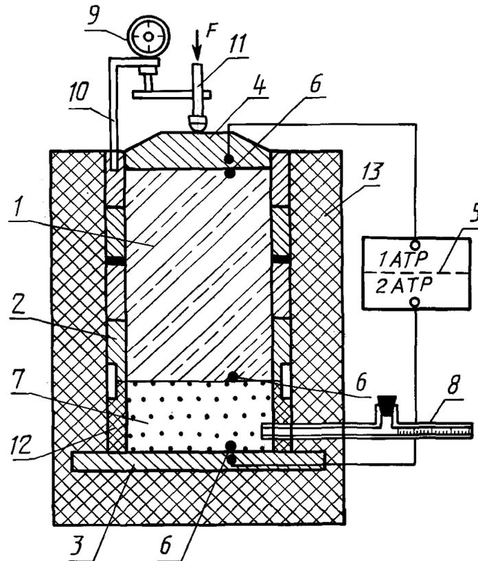
1 — образец грунта; 2 — обойма; 3 — нижняя термостатированная плита; 4 — верхняя термостатированная плита; 5 — блок автоматического терморегулирования; 6 — датчики температуры; 7 — капиллярно-пористый материал; 8 — устройство для подачи воды; 9 — индикатор перемещения; 10 — кронштейн; 11 — шток механизма для нагружения образца грунта; 12 — поддон обоймы; 13 — теплоизоляционный кожух
