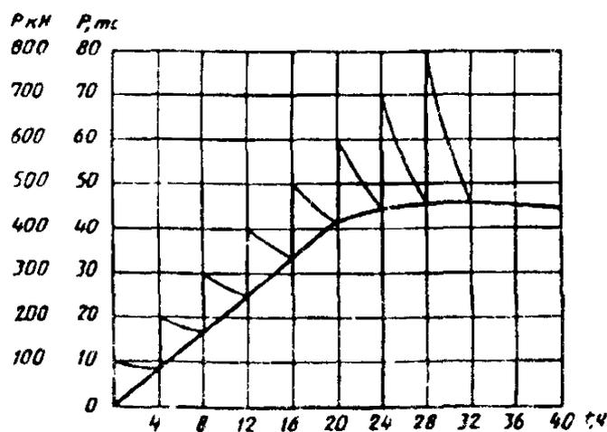
Рисунок 1 — График изменения нагрузки  $P$  во времени  $t$
