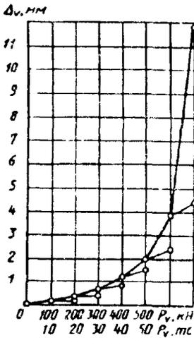
График изменения выхода сваи из грунта  $\Delta$  во времени  $t$  (по ступеням нагружения)
