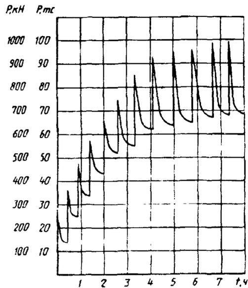
Рисунок 2 — График релаксации нагрузки за время испытания
