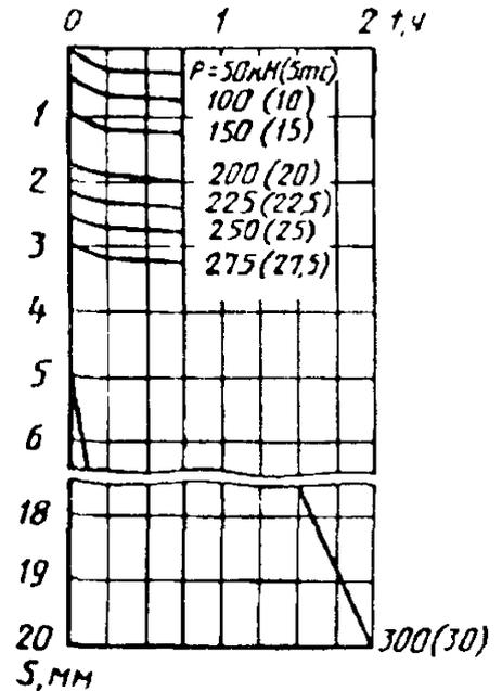
Примечание — Аналогично графику  $S = f(P)$  зависимости общей осадки сваи  $S$  от нагрузки  $P$  строят графики зависимости перемещений наконечника и ствола эталонных свай типов II и III и сваи-зонда от нагрузки.
