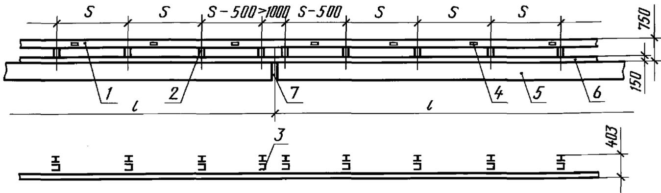
1 — балка; 2 — стойка; 3 — консоль-амортизатор; 4 — элемент световозвращающий; 5 — строение пролетное; 6 — цоколь;
