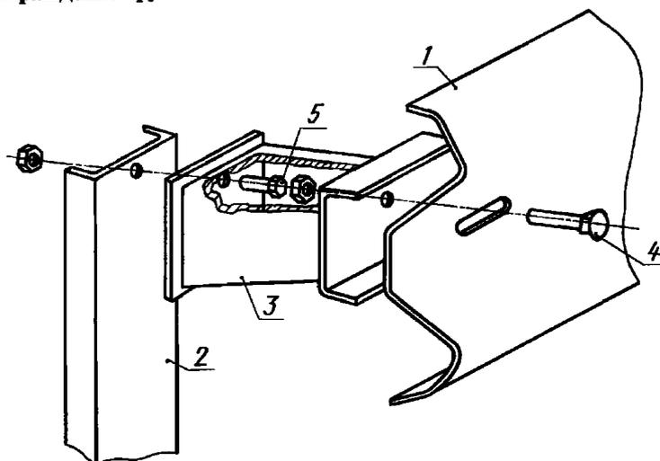
1 — балка; 2 — стойка; 3 — консоль жесткая; 4 — болт М16 × 45.58 ГОСТ 7802—81; 5 — болт М10 × 1,25—8g × 30.58 ГОСТ 7796—70
