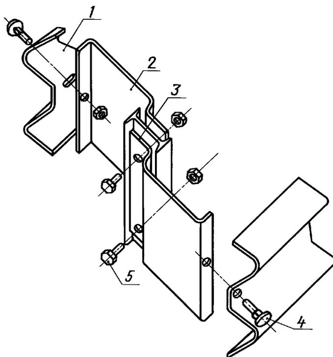
1 — балка; 2 — стойка; 3 — консоль-амортизатор; 4 — болт М16 × 45.58 ГОСТ 7802—81; 5 — болт М16 × 1,5—8g × 30.58
