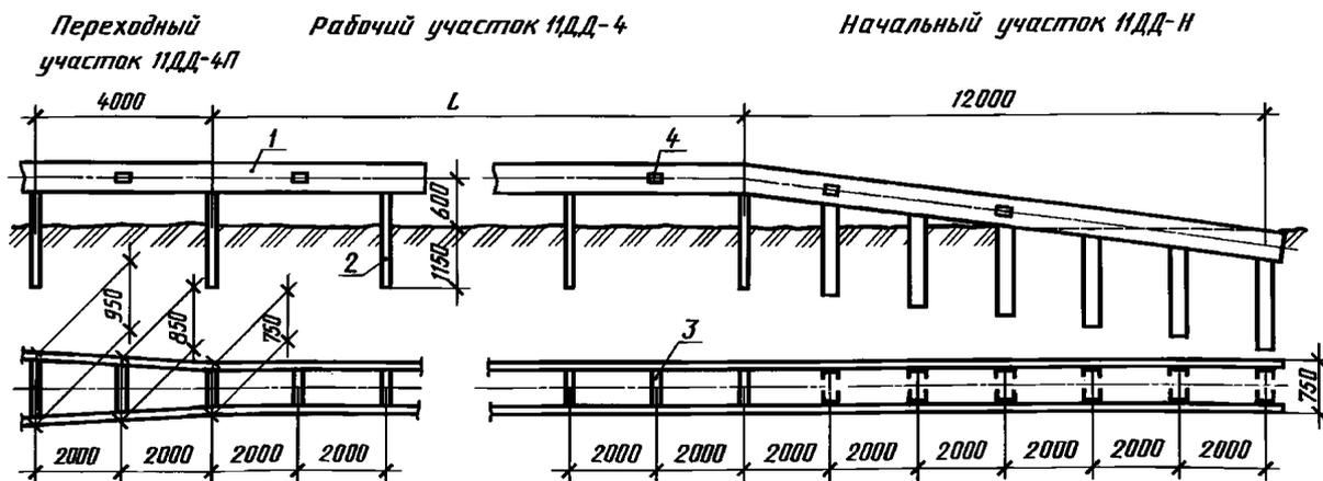
1 — балка; 2 — стойка; 3 — консоль-распорка; 4 — элемент световозвращающий
