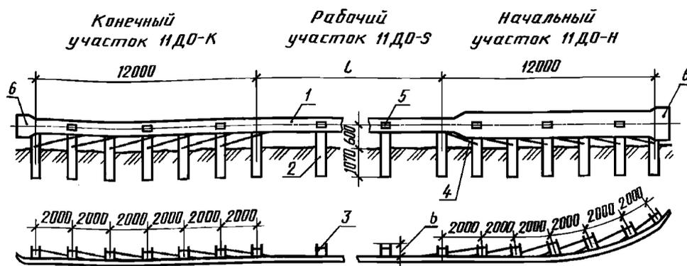
1 — балка; 2 — стойка; 3 — консоль жесткая; 4 — связь диагональная; 5 — элемент световозвращающий; 6 — элемент концевой
