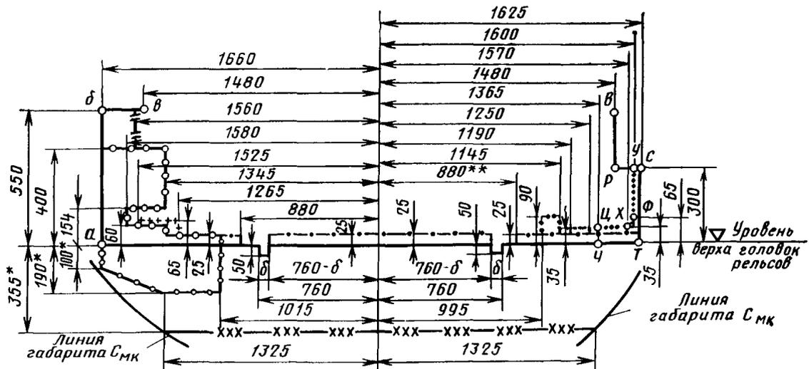
\* Размер следует увеличивать на 30 мм при укладке в путь рельсов типа Р65.
