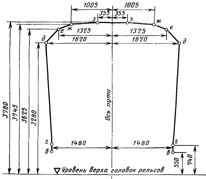
Примечание. Размеры по вертикали до точек д, е, ж, з допускается принимать уменьшенными на 30 мм для тоннелей кругового очертания при обращении вагонов типов Е, 81—714, 81—717, И (81—715 и 81—716) в случае укладки в путь рельсов типа Р65.
