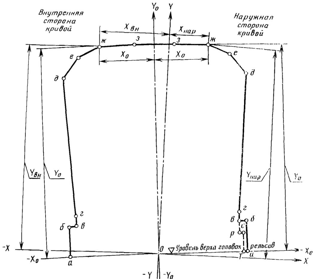
В первой системе координат габарит приближения оборудования в кривой симметричен относительно оси  $Y_0-Y_0$ , то есть координаты  $X_0$  и  $Y_0$  какой-либо его точки как для наружной, так и для внутренней стороны данной кривой установлены одинаковыми;
