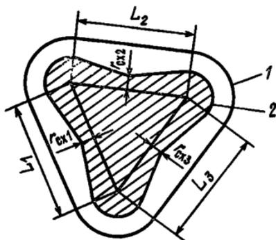
Рис. 10. Схема зоны защиты (в плане) множественного стержневого молниеотвода:  $L_1, L_2, L_3$  — расстояния между молниеотводами; 1, 2 — границы зон защиты на уровнях соответственно земли и высоты защищаемого сооружения
