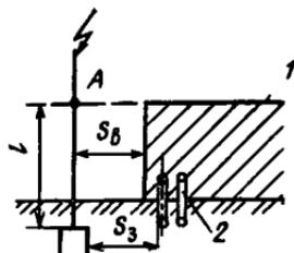
Рис. 1. Отдельно стоящий стержневой молниеотвод:  $l$  — протяженность токопровода от точки А до заземлителя;  $S_B$  — наименьшее допустимое расстояние до защищаемого сооружения;  $S_3$  — наименьшее допустимое расстояние от заземлителя до металлических коммуникаций; 1 — защищаемое сооружение; 2 — металлические коммуникации
