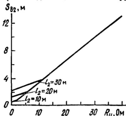
Рис. 5. Наименьшие допустимые расстояния от молниеотвода до защищаемого сооружения
