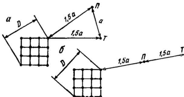
Рис. 16. Двухлучевая (а) и однолучевая (б) схемы расположения электродов при измерении сопротивлений сложных заземлений и одиночных горизонтальных полос: П — потенциальный электрод; Т — токовый электрод
