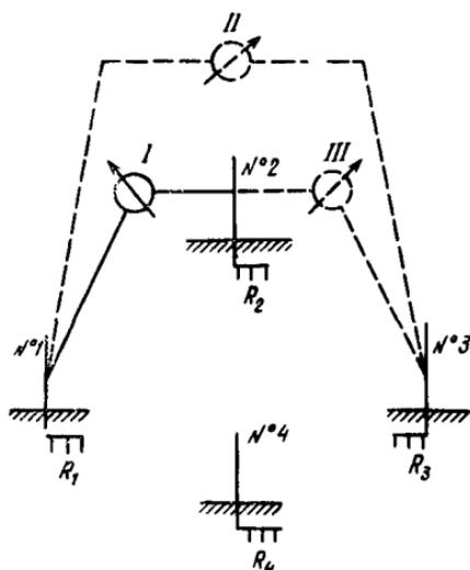
Рис. 17. Схема измерения сопротивления заземлителей способом трех измерений
