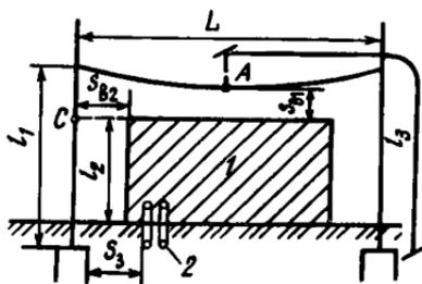
Рис. 2. Отдельно стоящий тросовый молниеотвод:  $L$  — расстояние между молниеотводами;  $l_1, l_3$  — протяженность токопроводов;  $h_2$  — высота защищаемого сооружения;  $S_{B1}, S_{B2}$  — наименьшие допустимые расстояния от тросового молниеотвода соответственно в точках А и С до защищаемого сооружения;  $S_3$  — наименьшее допустимое расстояние от заземления до металлических коммуникаций; 1 — защищаемое сооружение; 2 — металлические коммуникации.
