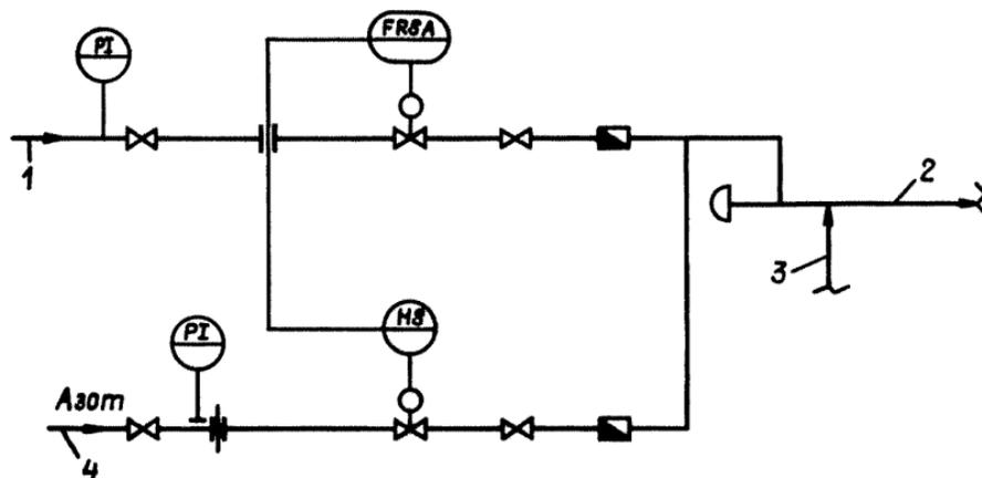
1 — подача продувочного (топливного) газа; 2 — факельный коллектор; 3 — источник сброса, наиболее удаленный от факельной установки; 4 — подача азота
