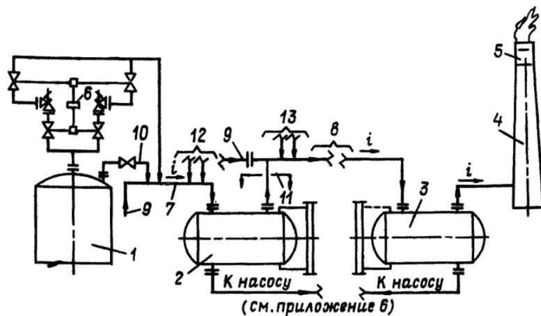
1 — защищаемый аппарат; 2 — цеховой сепаратор; 3 — факельный сепаратор; 4 — факельный ствол; 5 — газовый затвор; 6 — блокировочное устройство «закрыто—открыто»; 7 — цеховой коллектор; 8 — факельный коллектор; 9 — продувочный газ; 10 — линия ручного сброса; 11 — граница цеха; 12 — сброс газов от ПК на др. аппаратах цеха; 13 — сброс газов от др. цехов производства
