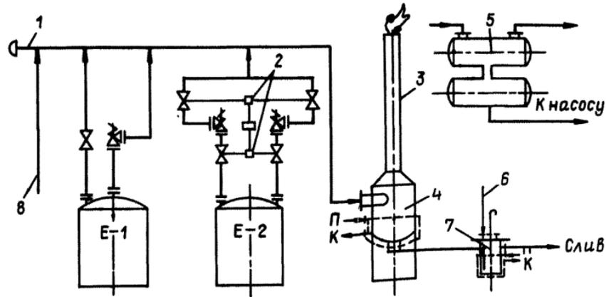
1 — факельный коллектор; 2 — блокировочное устройство; 3 — факельный ствол; 4 — сепаратор (вариант А); 5 — сепаратор (вариант В); 6 — подача затворной жидкости; 7 — гидрозатвор; 8 — продувочный газ
