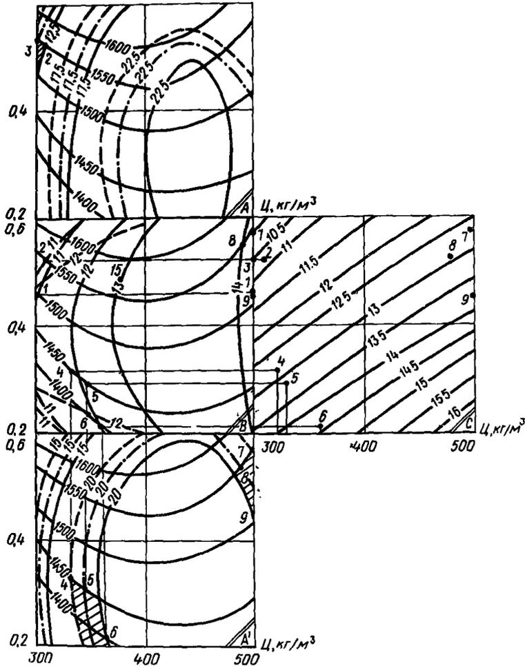
Комплексная номограмма для подбора составов конструкционного керамзитобетона на карбонатном песке, изготовленного из смеси исходной подвижностью ОК = 14 см: А, А' — номограммы " $R_{28}$ , МПа —  $\rho$ , кг/м<sup>3</sup>"; — — — содержание карбонатной пыли (фр. < 0,14) 45%П; - - - то же, 30%П; - - - то же, 15%П; В — номограмма; " $E_B \cdot 10^{-3}$ , МПа —  $\rho$ , кг/м<sup>3</sup>"; — — — расход химической добавки СДБ 0,5%Ц; - - - то же, 0,25%Ц; С — изолинии стоимости С, руб/м<sup>3</sup>
