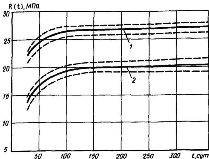
Рис. 2. Изменение во времени кубиковой прочности  $R(t)$  керамзитобетона на карбонатном песке, изготовленного из смеси исходной подвижностью ОК = 12 см при: 1 — высоком расходе цемента; 2 — низком расходе цемента; --- границы 95% доверительных интервалов
