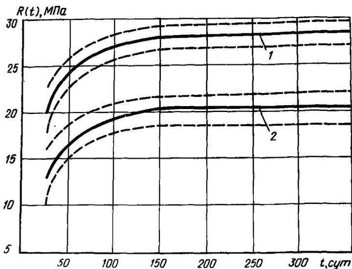
Рис. 3. Изменение во времени кубиковой прочности  $R(t)$  керамзитобетона на карбонатном песке, изготовленного из смеси исходной подвижностью ОК = 18 см при: 1 — высоком расходе цемента; 2 — низком расходе цемента; --- границы 95% доверительных интервалов
