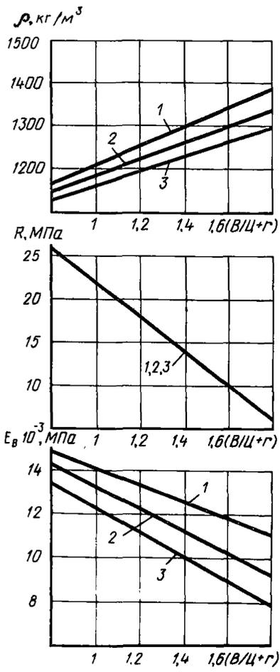
Рис. 2. Зависимость прочности  $R$ , модуля упругости  $E_B$  и плотности  $\rho$  керамзитобетона на карбонатном песке от обобщенного фактора состава  $\Phi = (B/C + r)$
