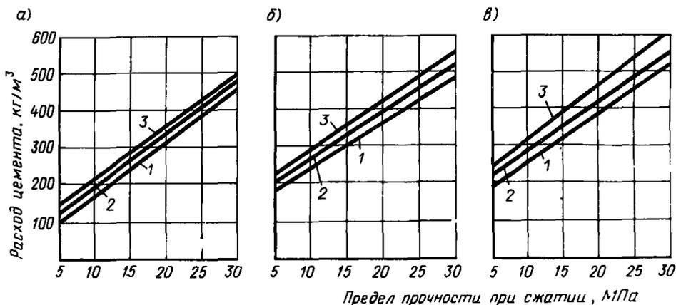
Рис. 1. Зависимость прочности керамзитобетона на карбонатном песке от расхода цемента при исходной подвижности смеси ОК = 6-8 см (а); ОК = 14 см (б), ОК = 16-19 см (в)
