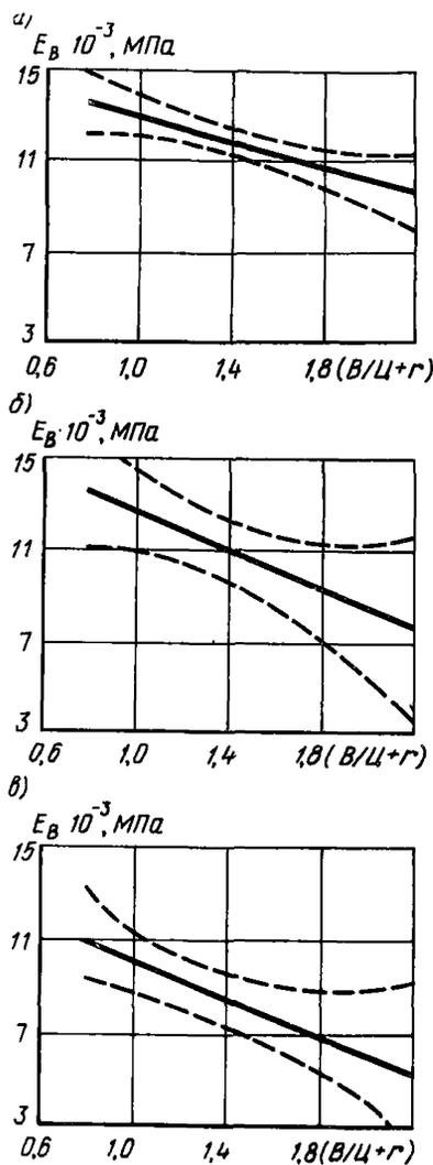
Рис. 2. Зависимость модуля упругости  $E_B(28)$  керамзитобетона на карбонатном песке от обобщенного фактора состава  $\Phi = (B/C + r)$  при исходной подвижности смеси ОК = 6 см (а), ОК = 12 см (б), ОК = 18 см (в); - - - - границы 95% доварительных интервалов
