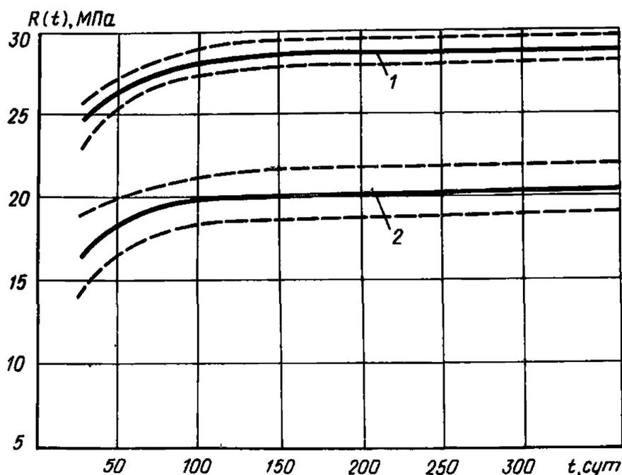
Рис. 1. Изменение во времени кубиковой прочности  $R(t)$  керамзитобетона на карбонатном песке, изготовленного из смеси исходной подвижностью ОК = 6 см при 1 — высоком расходе цемента; 2 — низком расходе цемента; -----границы 95% доверительных интервалов
