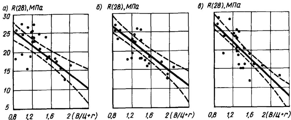
Рис. 1. Зависимость кубиковой прочности  $R(28)$  керамзитобетона на карбонатном песке от обобщенного фактора состава  $\Phi = (B/\text{Ц} + r)$  при исходной подвижности смеси ОК = 6 см (а), ОК = 12 см (б), ОК = 18 см (в); ---- — границы 95% доверительных интервалов
