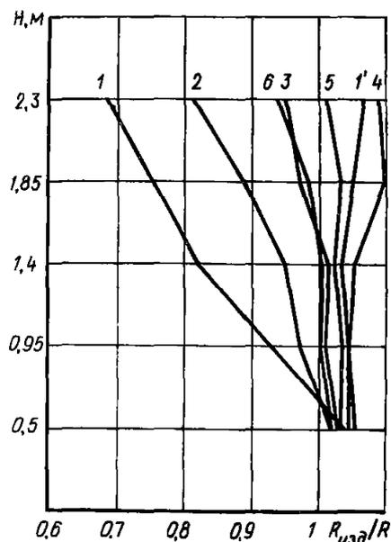
зительно на уровне 1/2 высоты фрагмента. Причем, в этом месте  $R_{изд}$  в наибольшей степени соответствует  $R$ . Дальнейшее изменение прочности по высоте фрагмента зависит от состава керамзитобетона, его прочности и исходной подвижности смеси. Наилучшую однородность прочности показали фрагменты, изготовленные из керамзитобетона класса по прочности на осевое сжатие В20 (ОК=6 см).
