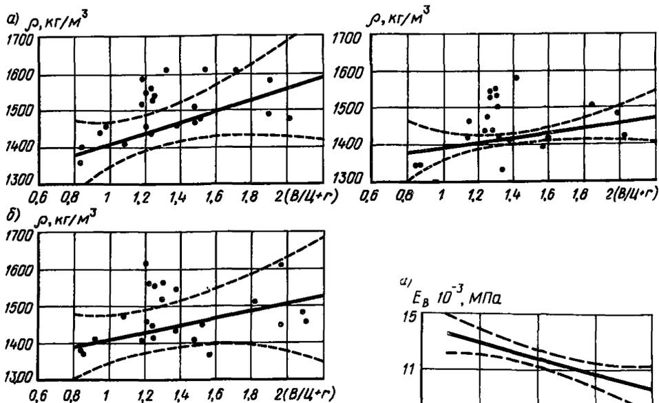
Рис. 3. Зависимость плотности в сухом состоянии  $\rho$  керамзитобетона на карбонатном песке от обобщенного фактора состава  $\Phi = (B/C + r)$  при исходной подвижности смеси ОК = 6 см (а), ОК = 12 см (б), ОК = 18 см (а); - - - - границы 95% доверительных интервалов
