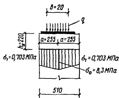
Черт. 10. Распределение напряжений в кладке под опорной плитой в поперечном направлении
