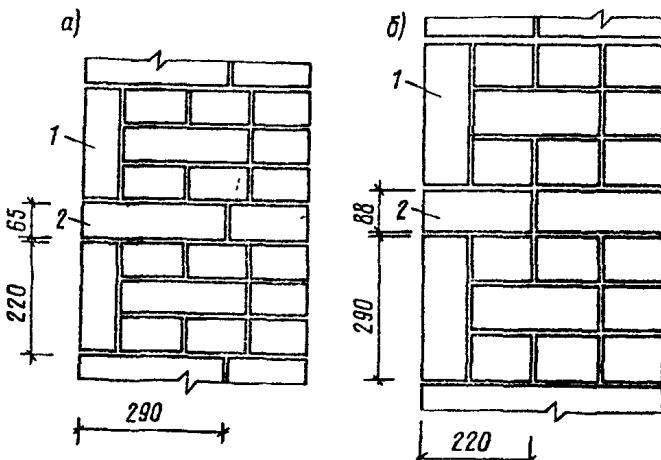
Черт. 46. Облицовка стен плоскими бетонными плитами
