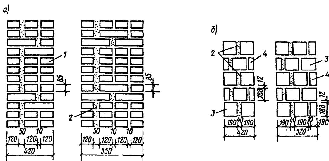
а - кирпичная кладка; б - из бетонных камней с щелевидными пустотами; 1 - кирпичная кладка; 2 - уширенный шов, заполненный теплоизоляционным материалом или раствором; 3 - целый камень; 4 - продольная половина
