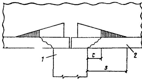
Черт. 52. Определение поперечной силы у опоры рандбалки
