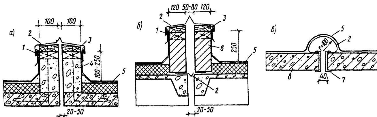
Черт. 62. Примеры устройства температурных швов в железобетонных крышиах
