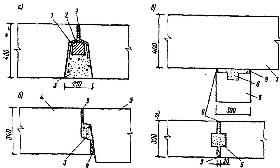
Черт. 42. Схема заделки вертикальных стыков между блоками
