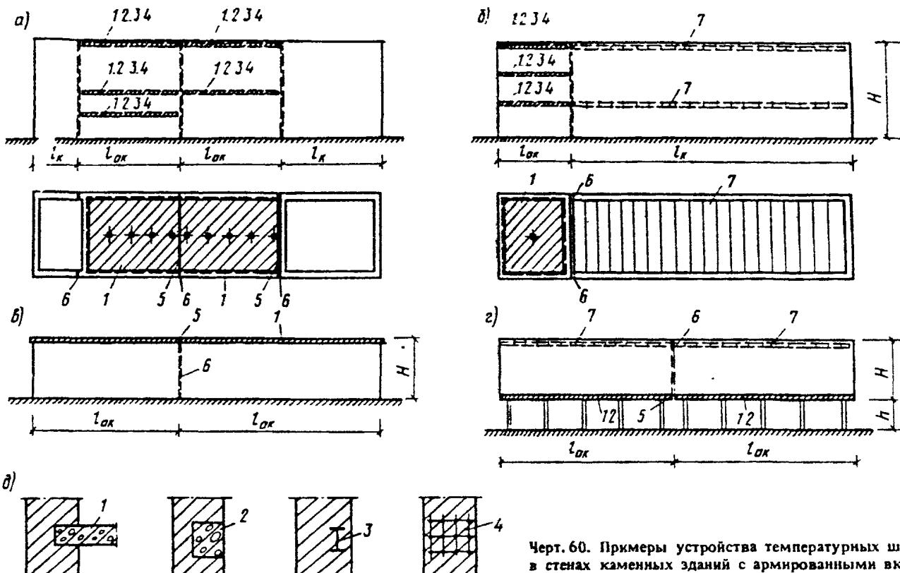
Черт. 60. Примеры устройства температурных швов в стенах каменных зданий с армированными включениями (перекрытия, балки, армированные пояса)
