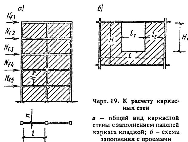
Черт. 19. К расчету каркасных стен
