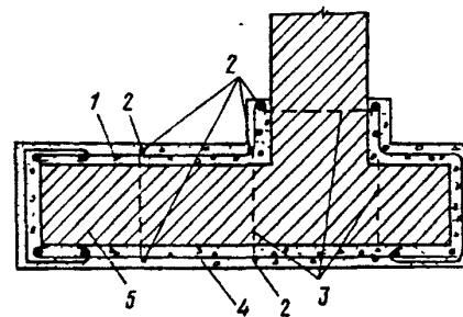
Черт. 16. Схема усиления стены железобетонной обоймой
