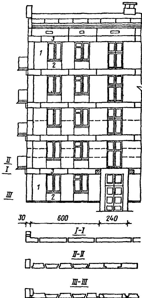
Черт. 39. Фрагмент фасадной стены из кирпичных блоков при двухрядной разрезке
