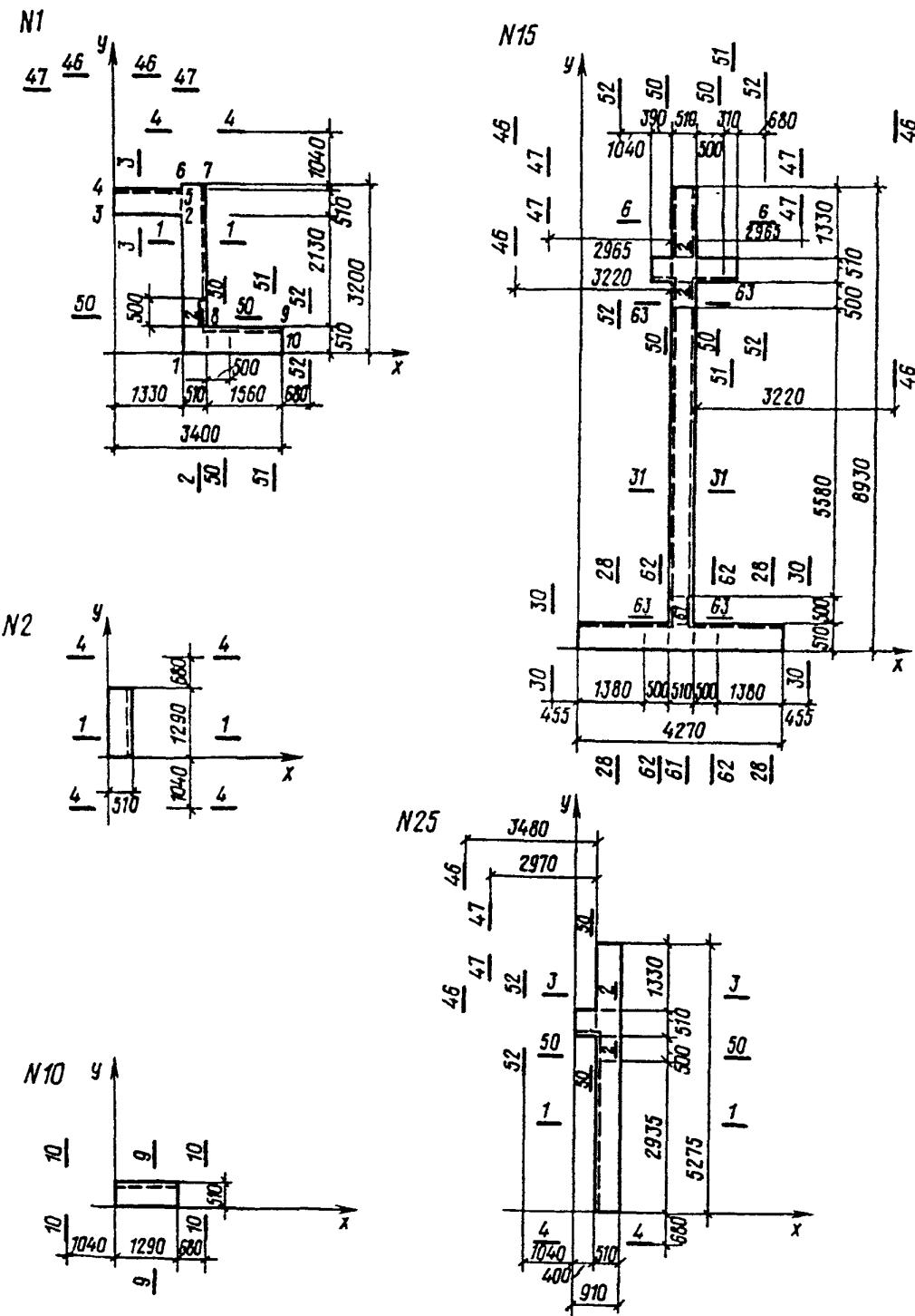
Черт. 11. Геометрические размеры горизонтальных сечений рассматриваемых элементов
