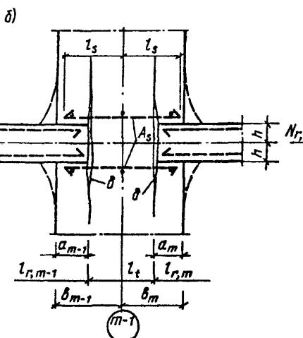
Черт. 9. Работа армированной кладки при образовании трещин в местах заделки армированных элементов
