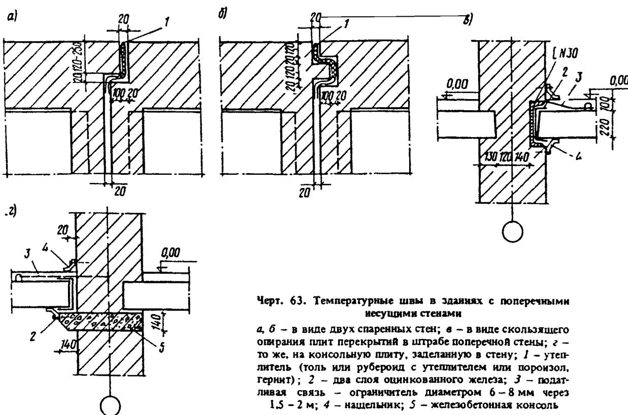
Черт. 63. Температурные швы в зданиях с поперечными несущими стенами
