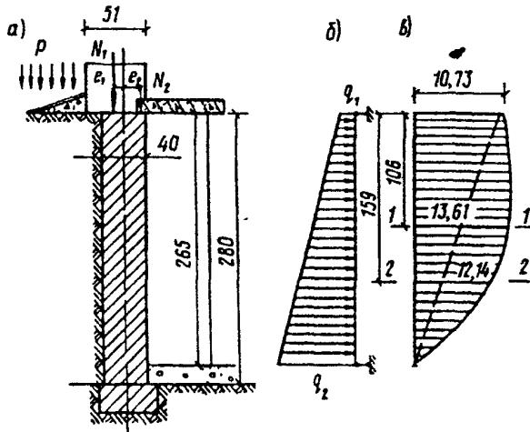
Черт. 57. Расчет стены подвала
