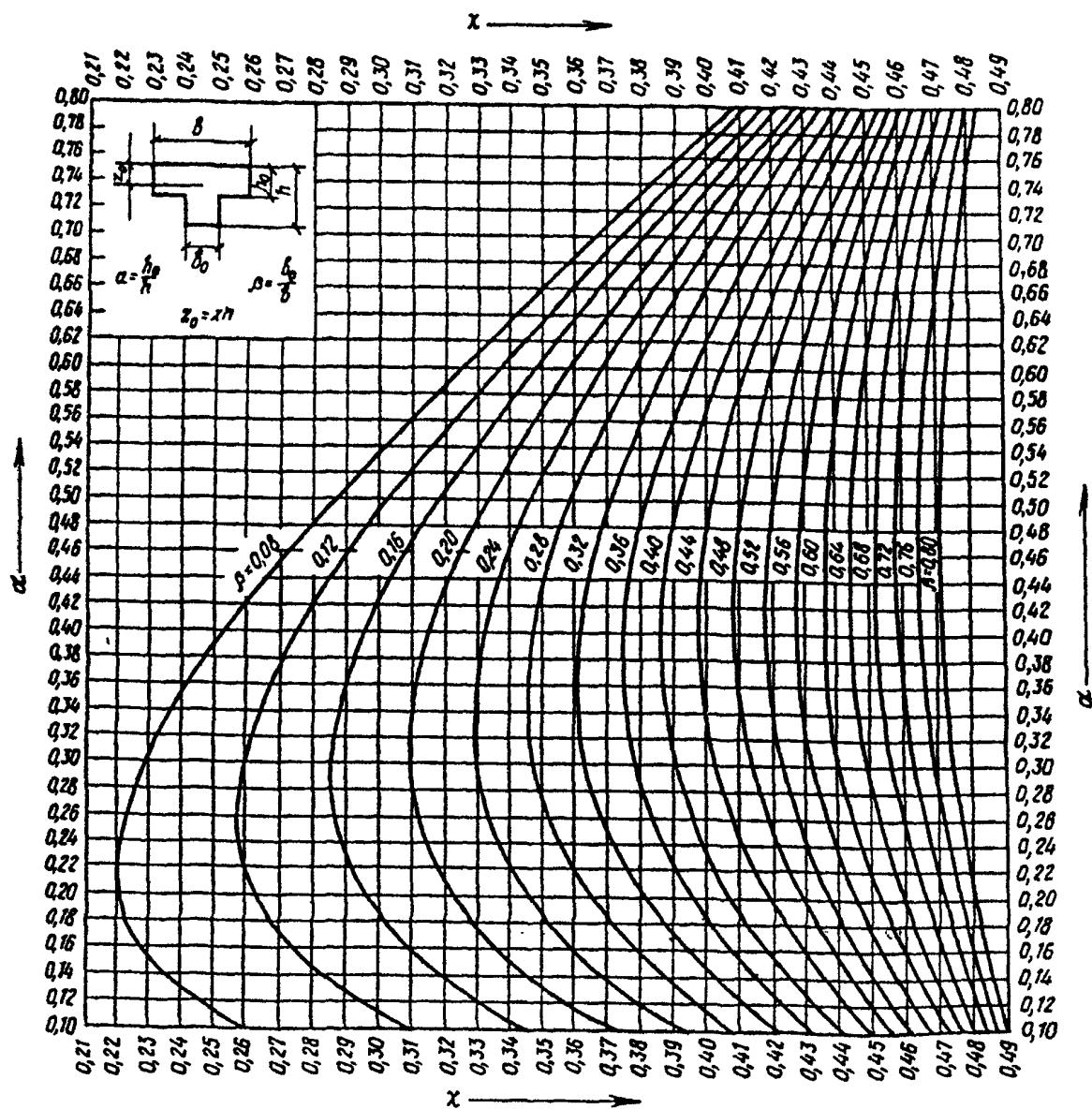
Б. ГРАФИК ДЛЯ ОПРЕДЕЛЕНИЯ МОМЕНТОВ ИНЕРЦИИ
