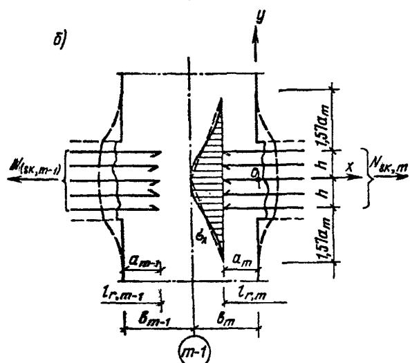
Черт. 8. Напряженно-деформированное состояние простенка в местах заделки в него элементов
