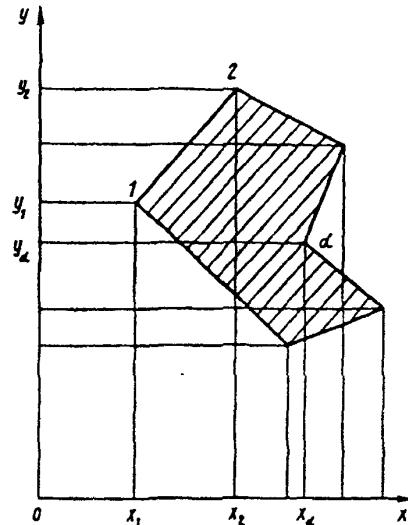
Черт. 1. Нумерация вершин горизонтальных сечений стен здания
