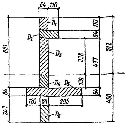
Черт. 22. Схема для определения коэффициента  $K$  стены № 1
