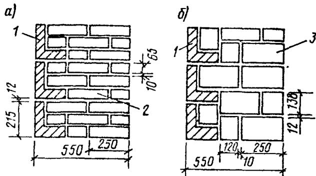
Черт. 45. Облицовка стен Г-образными закладными бетонными плитами
