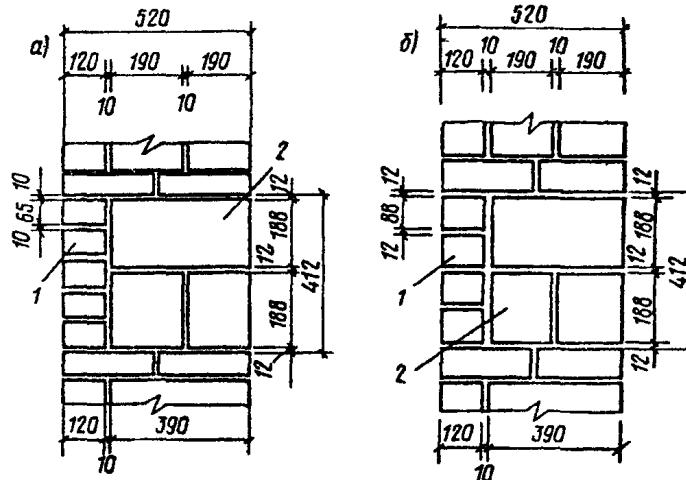
Черт. 47. Облицовка фасадов стен из бетонных камней
