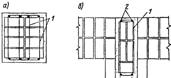
Черт. 12. Продольное армирование кирпичных конструкций (столов, стен и др.)
