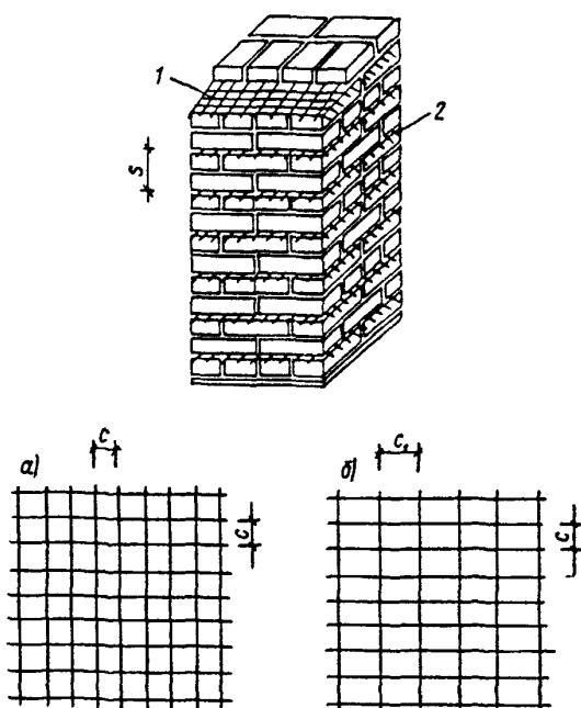
5.12. Не допускается применять сетчатое армирование стен помещений с влажным и мокрым режимами.
