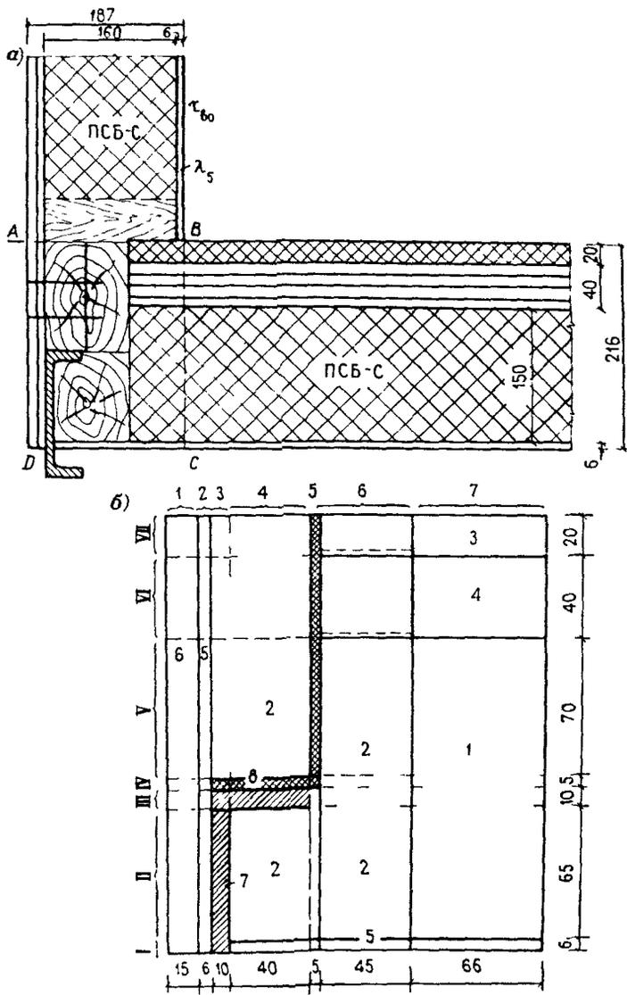
Рис.6. Поперечный разрез углового соединения панелей стены и пола (а) и его расчетная схема (б)
