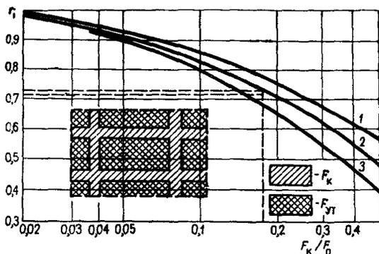
Рис.2. График для определения коэффициента  $\eta_1$  при  $\lambda_{ут}/\lambda_k$  равном:
