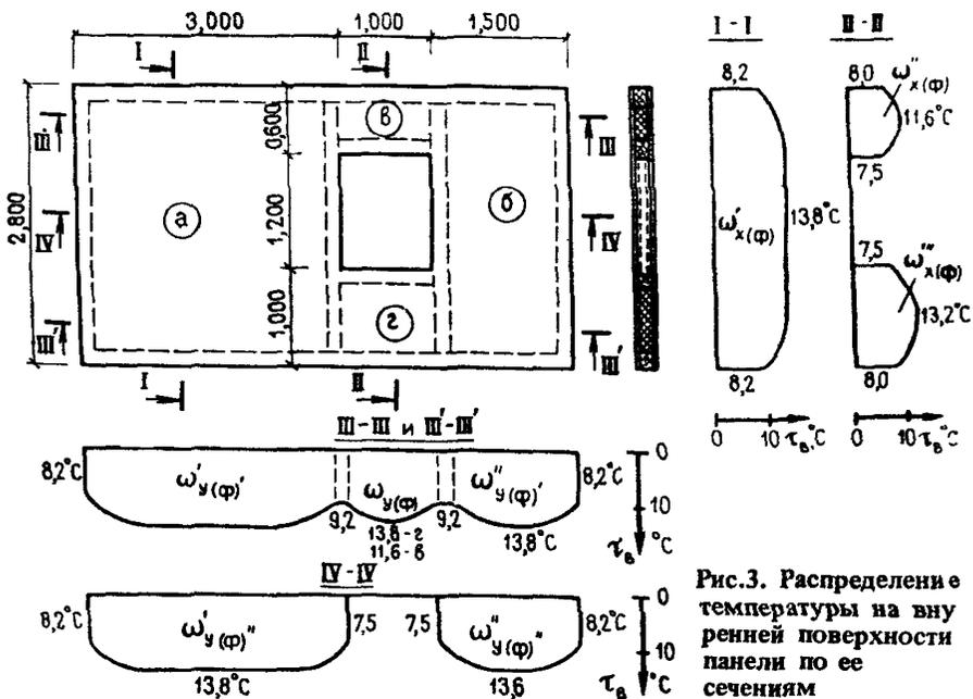
Рис.3. Распределение температуры на внутренней поверхности панели по ее сечениям
