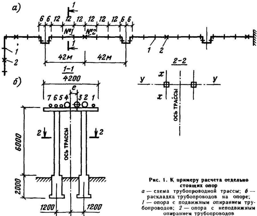
**Рис. 1.** К примеру расчета отдельно стоящих опор
