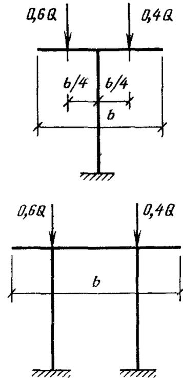
Рис. 18. Распределение вертикальной нагрузки при расчете колонн и фундаментов промежуточных отдельно стоящих опор по поперечному сечению трассы  $Q = pb$  — вертикальная нагрузка на опору или на соответствующий ярус опоры ( $p$  — значение интенсивности вертикальной нагрузки на единицу длины траверсы)
