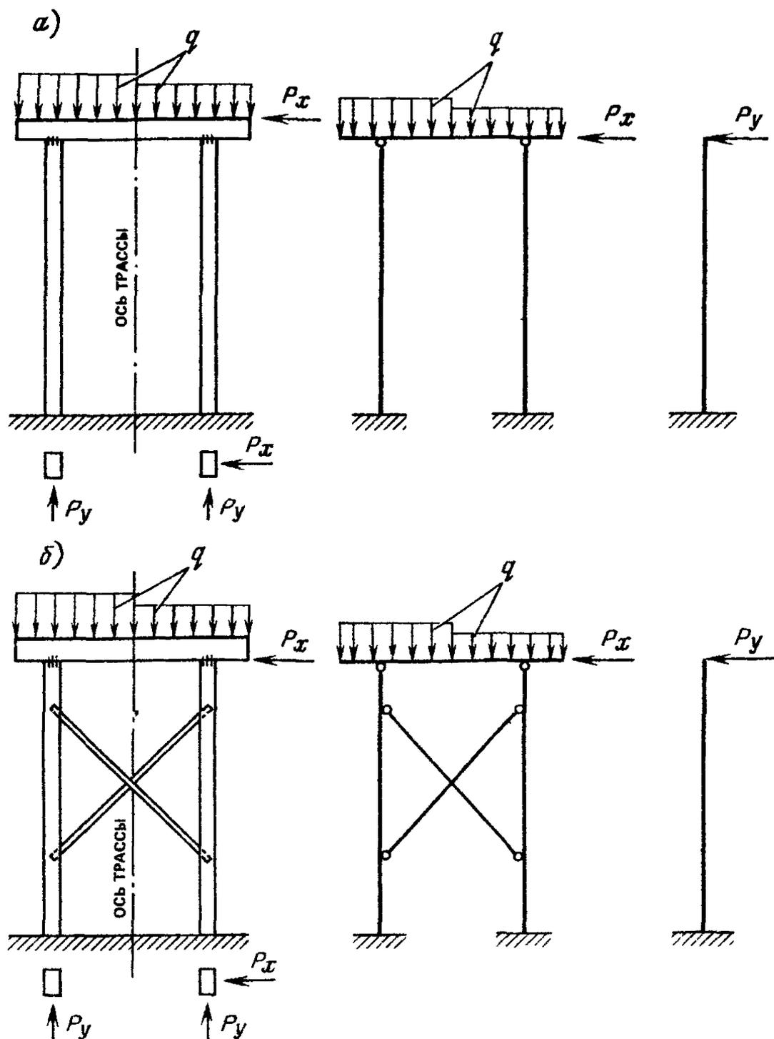
Рис. 29. Расчетные схемы железобетонных опор
