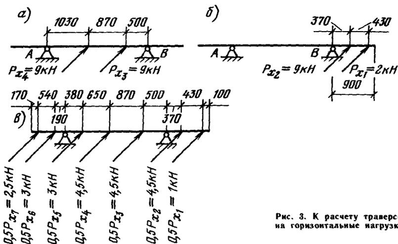
Рис. 3. К расчету траверсы на горизонтальные нагрузки
