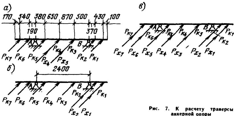
Рис. 7. К расчету траверсы анкерной опоры
