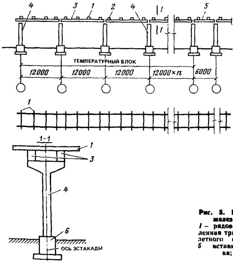
**Рис. 5. Конструктивная схема железобетонных эстакад**
