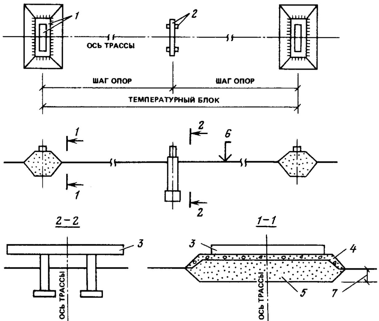
Рис. 2. Конструктивная схема шпальных отдельно стоящих опор
