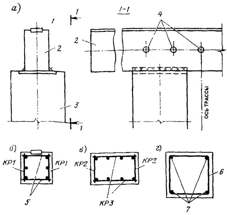
**Рис. 4. Конструкции железобетонных отдельно стоящих опор**
