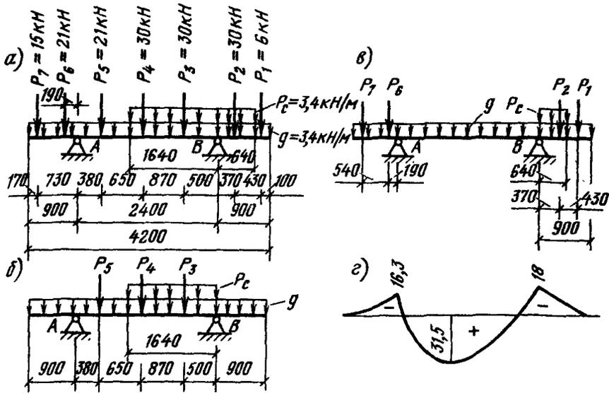
Рис. 2. К расчету траверсы на вертикальные нагрузки
