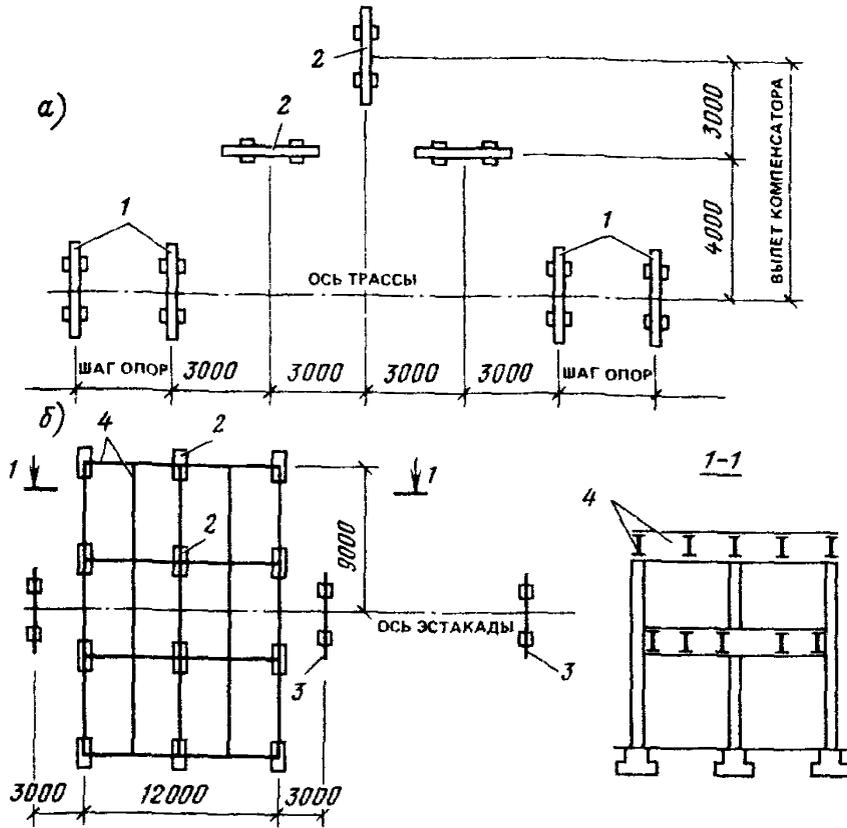
Рис. 9. Пример решения опор под компенсаторы
