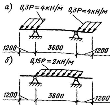
Рис. 11. К расчету рядовой траверсы на горизонтальные нагрузки
