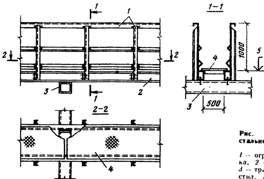
Рис. 15. Конструкция стального проходного мостика
