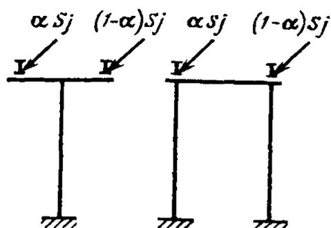
Рис. 27. Распределение сейсмической нагрузки по поперечному сечению трассы при расчете колонн и фундаментов эстакад. При  $q \leq 10$  кН/м  $\alpha = 0,65$ , при  $q = 10 - 30$  кН/м  $\alpha = 0,6$ , при  $q > 30$  кН/м  $\alpha = 0,55$ . Состав нагрузки  $q$  указан в п. 4.4
