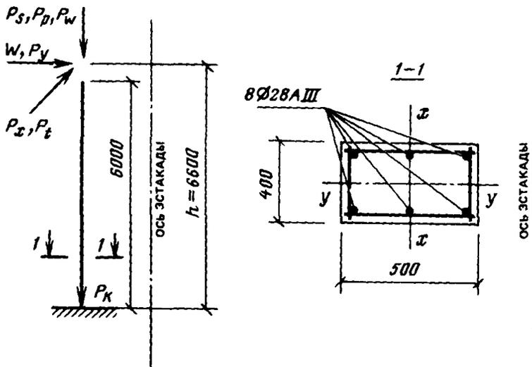
Рис. 16. Расчетная схема колонны эстакады
