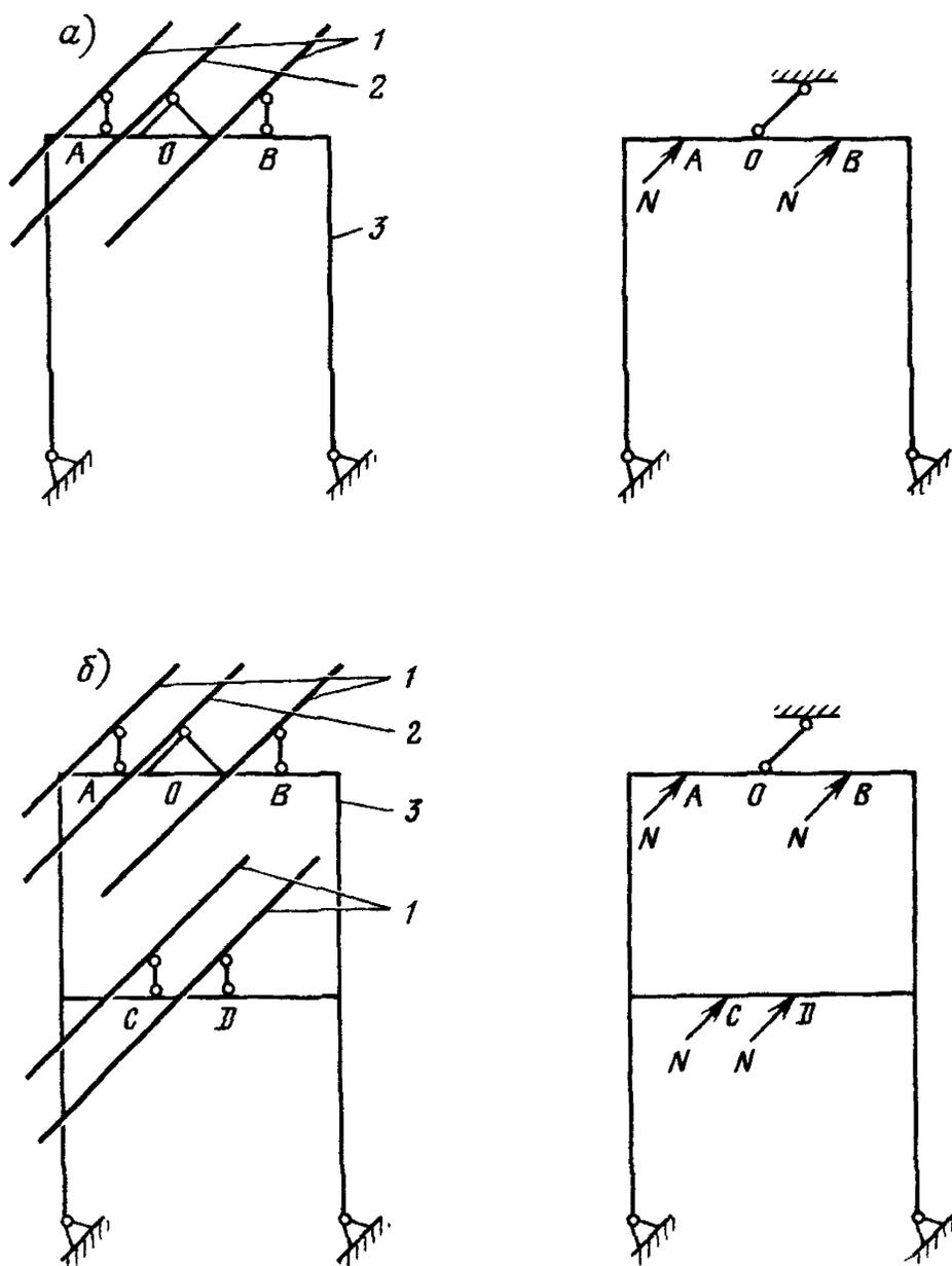
Рис. 32. Расчетные схемы двухшарнирных опор
