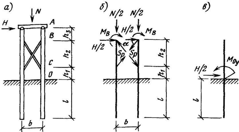
Рис. 33. Расчетная схема опоры с применением свай-колонны
