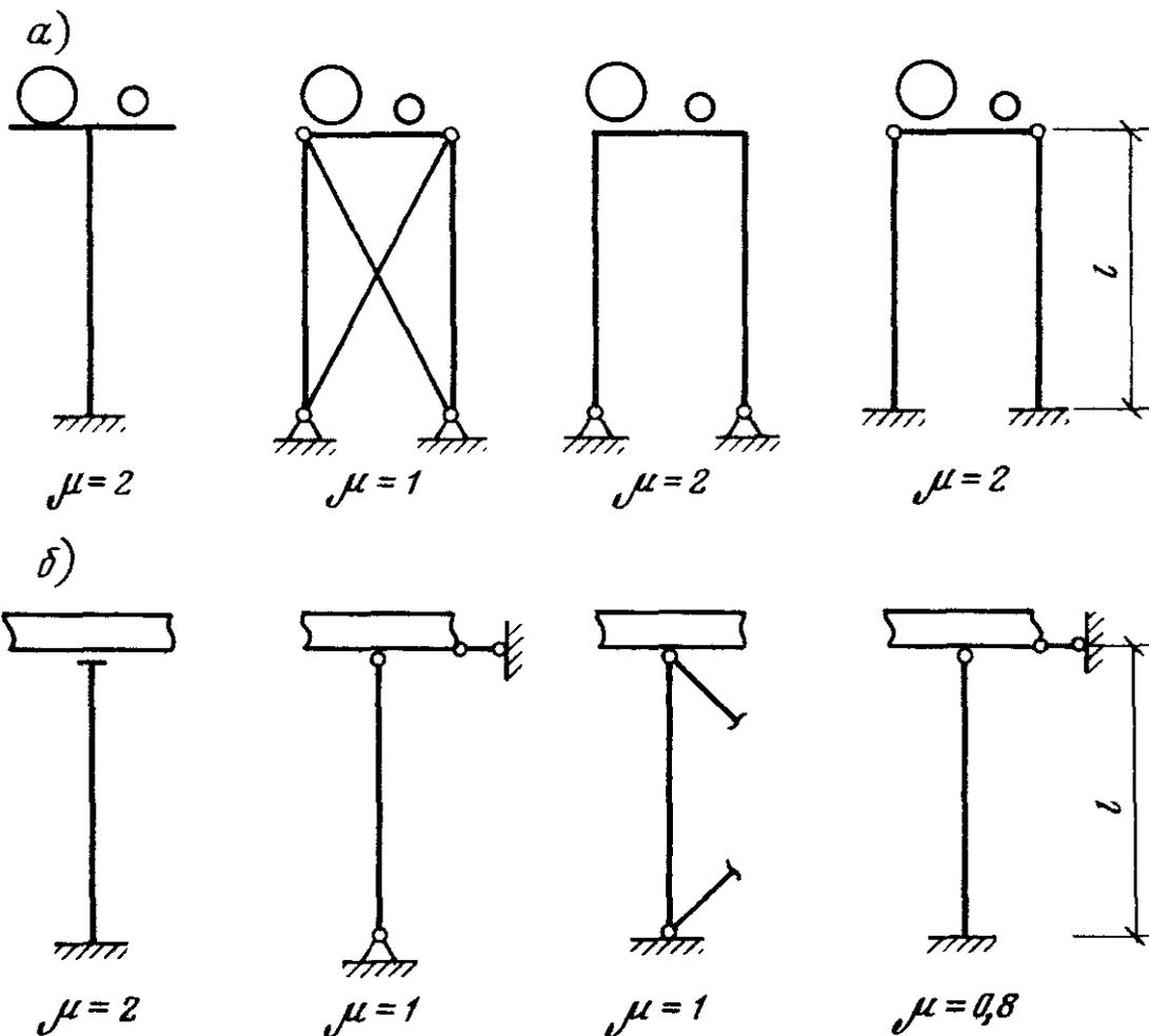
Рис. 31. Значение коэффициентов для определения расчетных длин  $l_0 = \mu l$  колонн опор
