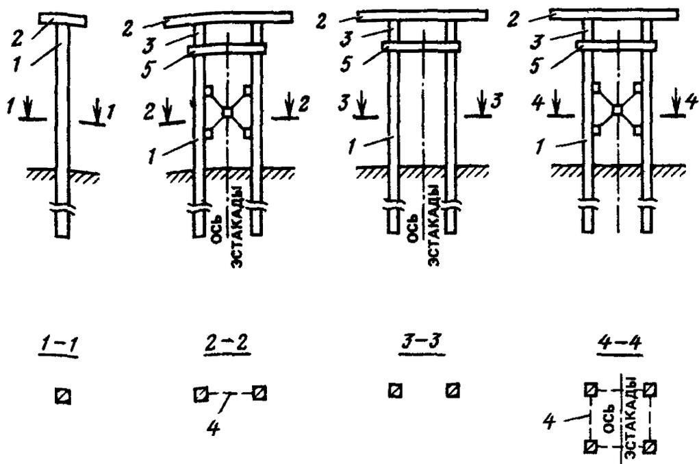
Рис. 11. Типы опор с применением свай-колонн
