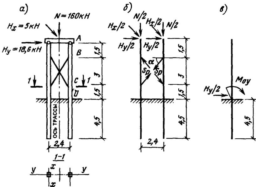
Рис. 18. Расчетная схема опоры с применением свай-колонн, усиленных крестовыми связями
