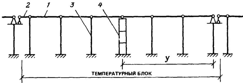
**Рис. 28. Расчетная схема эстакады в продольном направлении**
