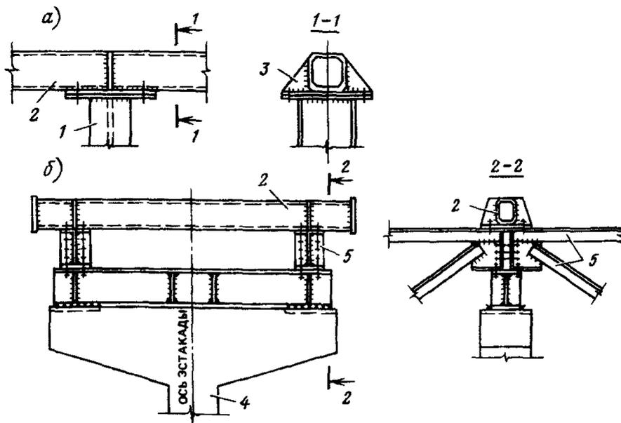
Рис. 8. Узлы опирания стальных конструкций
