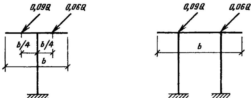
Рис. 23. Распределение горизонтальной нагрузки при расчете колонн и фундаментов промежуточных отдельно стоящих опор по поперечному сечению трассы  $Q = pb$  — вертикальная нагрузка на опору или на соответствующий ярус опоры ( $p$  — значение интенсивности вертикальной нагрузки на единицу длины траверсы)
