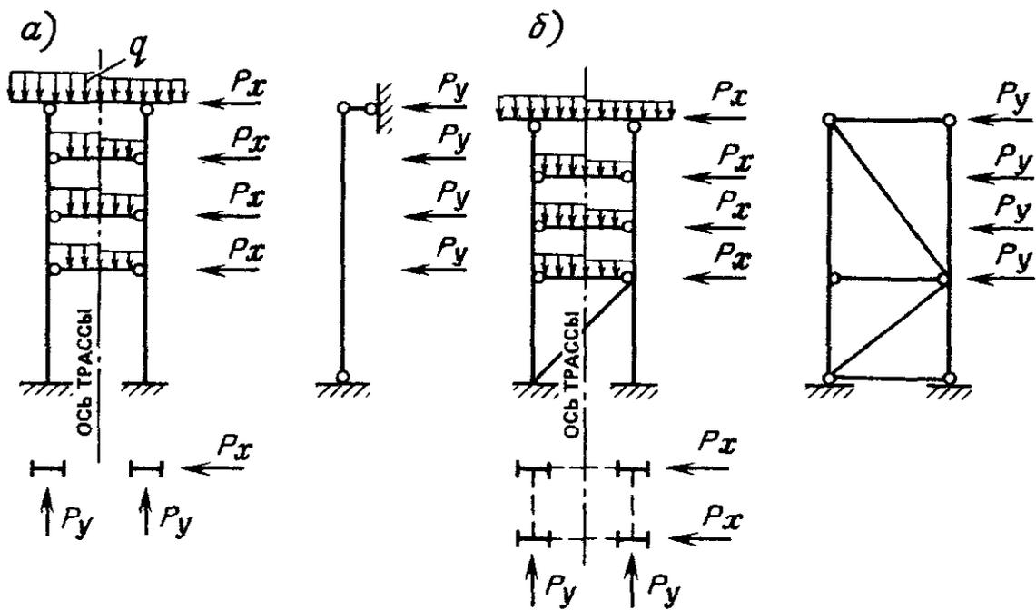
Рис. 30. Расчетные схемы стальных многоярусных опор
