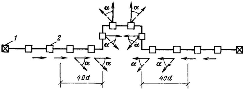
**Рис. 21.** Направления горизонтальной нагрузки в местах подвижного опирания трубопроводов на отдельно стоящие опоры при нагревании трубопроводов  $\alpha = 45^\circ$  — в скользящих опорных частях,  $\alpha = 70^\circ$  в катковых
