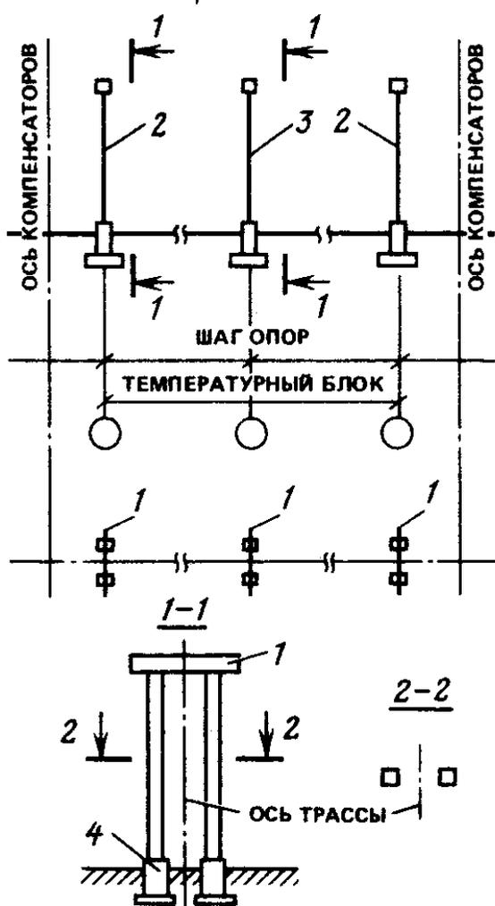
Рис. 3. Конструктивная схема отдельно стоящих железобетонных опор
