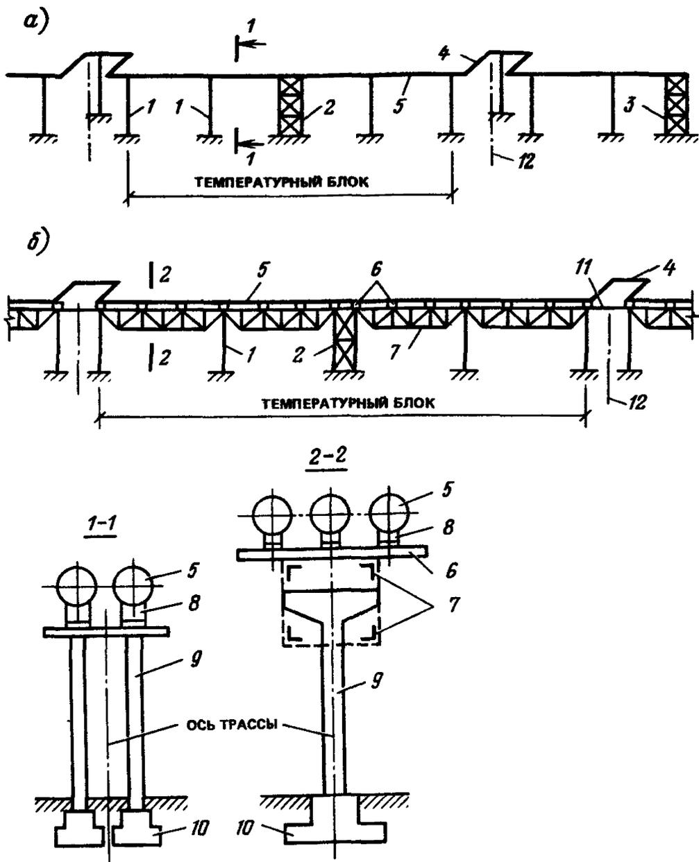
**Рис. 1. Схема прокладки трубопроводов по опорам и эстакадам**
