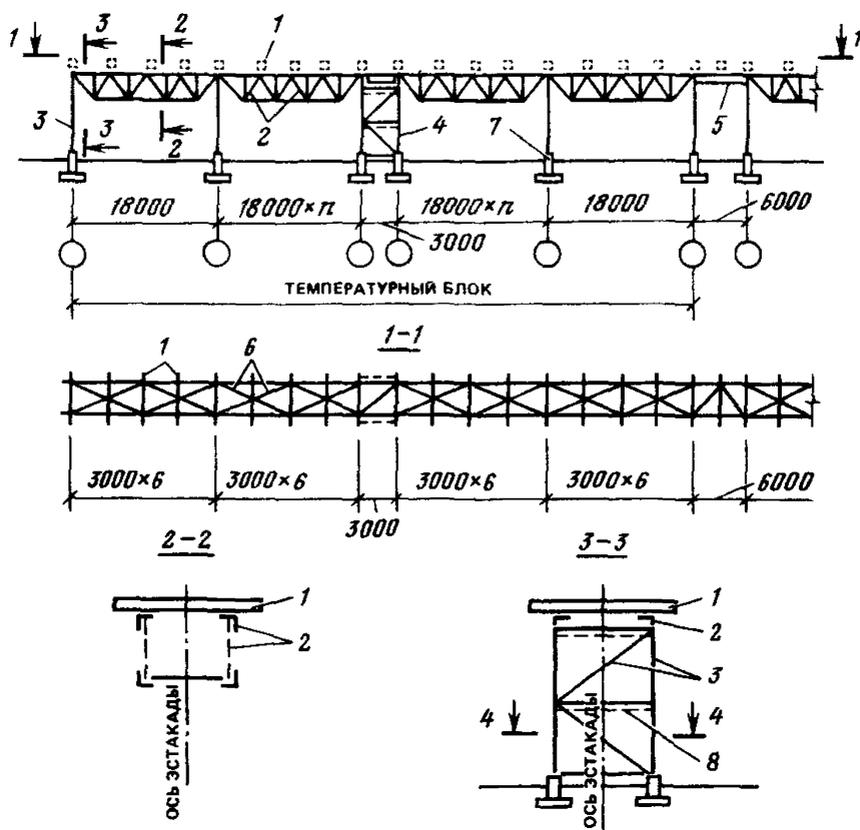
Рис 7 Конструктивная схема одноярусной стальной эстакады
