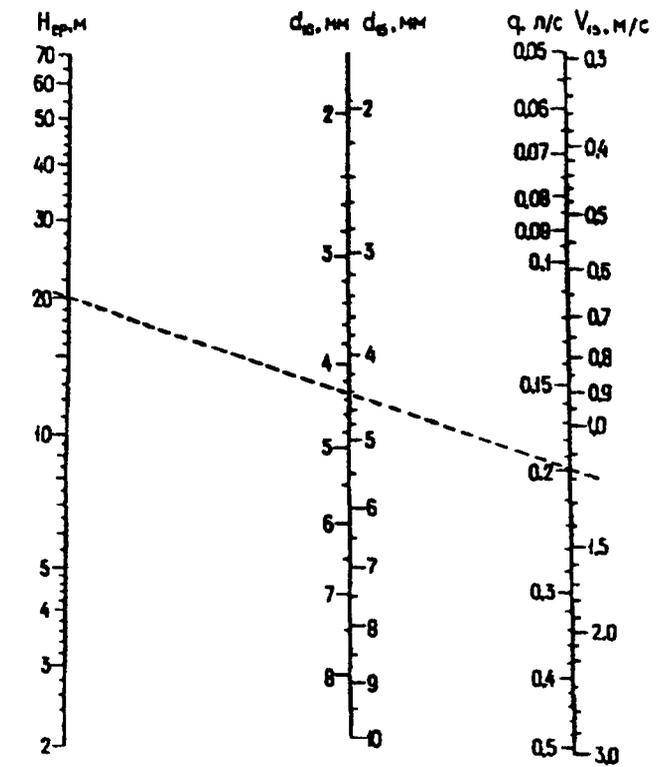
Черт. 5. Номограмма для определения диаметров отверстий диафрагм, устанавливаемых между соединительными головками и пожарными кранами
