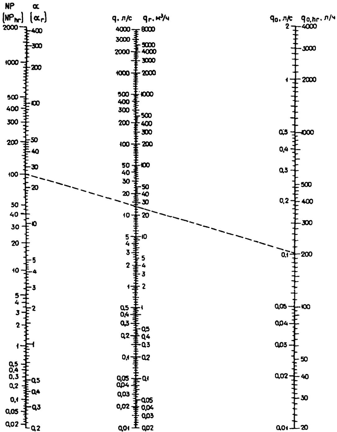
Черт. 4. Номограмма для определения секундных и часовых расходов воды в зависимости от NP (NP<sub>hr</sub>) при различных значениях q<sub>0</sub>, л/с, q<sub>0,hr</sub>, л/ч
