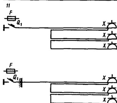
Примечания: 1. Присоединение электроприемников в цепочку осуществляется без разрыва проводов.
