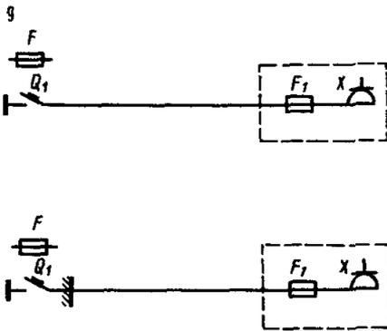
Панель защиты с двумя предохранителями АПР-10 и розеткой входит в комплект поставки
