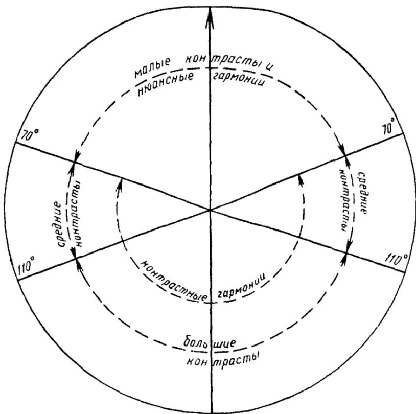
Рисунок следует перенести на лист целлулоида или другого прозрачного материала, вырезать по окружности, наложить на цветовой круг (приложение V) и скрепить в центре так, чтобы прозрачный диск мог свободно вращаться.
