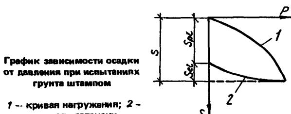
4. Если при полевых испытаниях грунтов штампами или при компрессионных испытаниях образцов грунтов кривые разгрузки не определялись, то следует принимать значение
