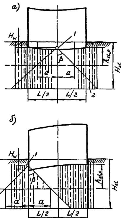
Черт. 3. Схемы вертикальных перемещений основания здания (сооружения) при просадке грунтов от внешней нагрузки
