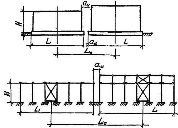
Черт. 3. Схемы для определения размеров деформационного шва между отсеками
