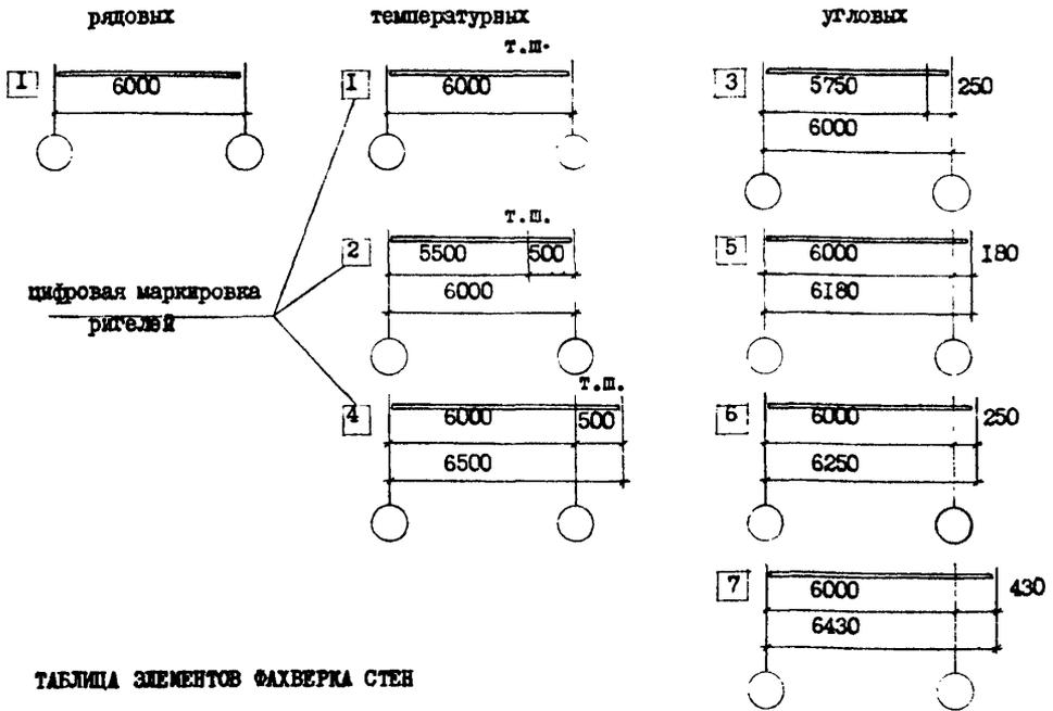
ТАБЛИЦА ЭЛЕМЕНТОВ ФАХВЕРКА СТЕН
